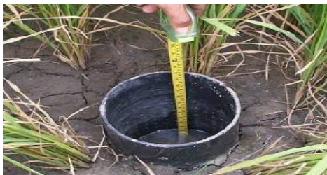
(그림 3) 효율적인 관개를 위한 물관리 제어 장치
