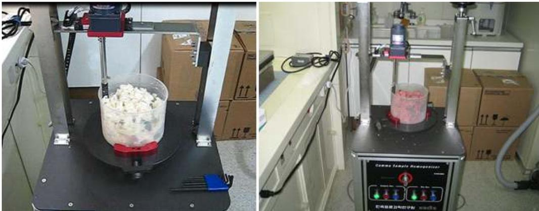
그림 3.3.1.7. 시료에 선원첨가 후 시료균질기를 이용하여 대구와 소고기시료를 혼합
