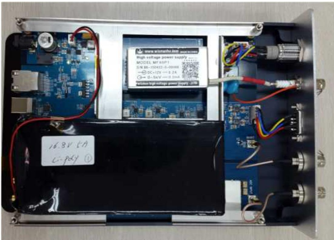
그림 3.2.3.4. Li-ion 배터리가 장착된 NeoMCA 내부
