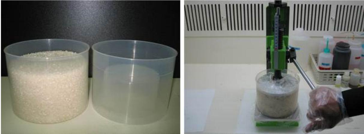
그림 3.3.1.8. 시료 압축기를 사용한 시료높이 보정
