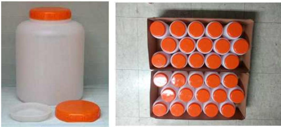
그림 3.3.2.10. 최종 개발된 Cs-137측정용 밀가루 인증표준물질
