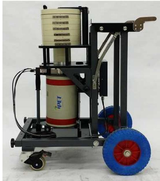
그림 3.2.2.18. 조립 완료된 HPGe 검출기형 이동형 방사능 분석장비
