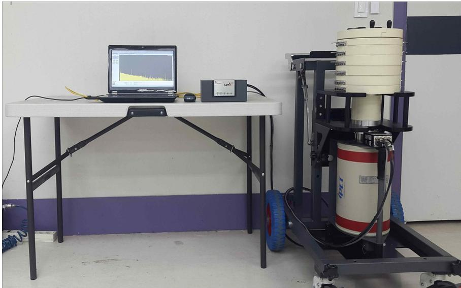
그림 3.2.4.27. 테스트 실험장비: Canberra Lynx with HPGe crystal
