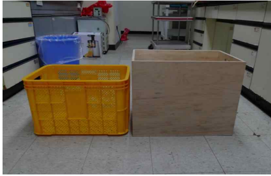
그림 2-81. 기존 플라스틱 박스와 배추전용 목업상자 외관비교
