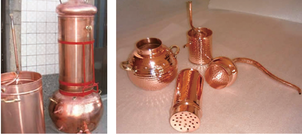
【그림 8-27】 약재 추출이 가능한 소형 증류 장치(호가 - Hoga, 스페인)
