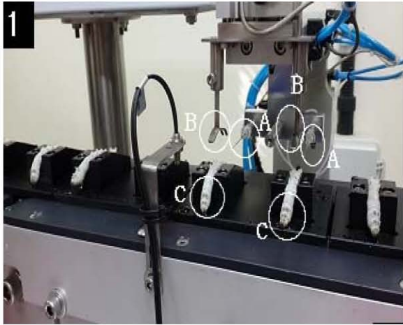
1 유도액 주입 시린지부(A), 누에 고정을 위한 고정부(B) 및 지지부에 부착된 누에(C)에 면역유도액 주입을 준비하는 단계
