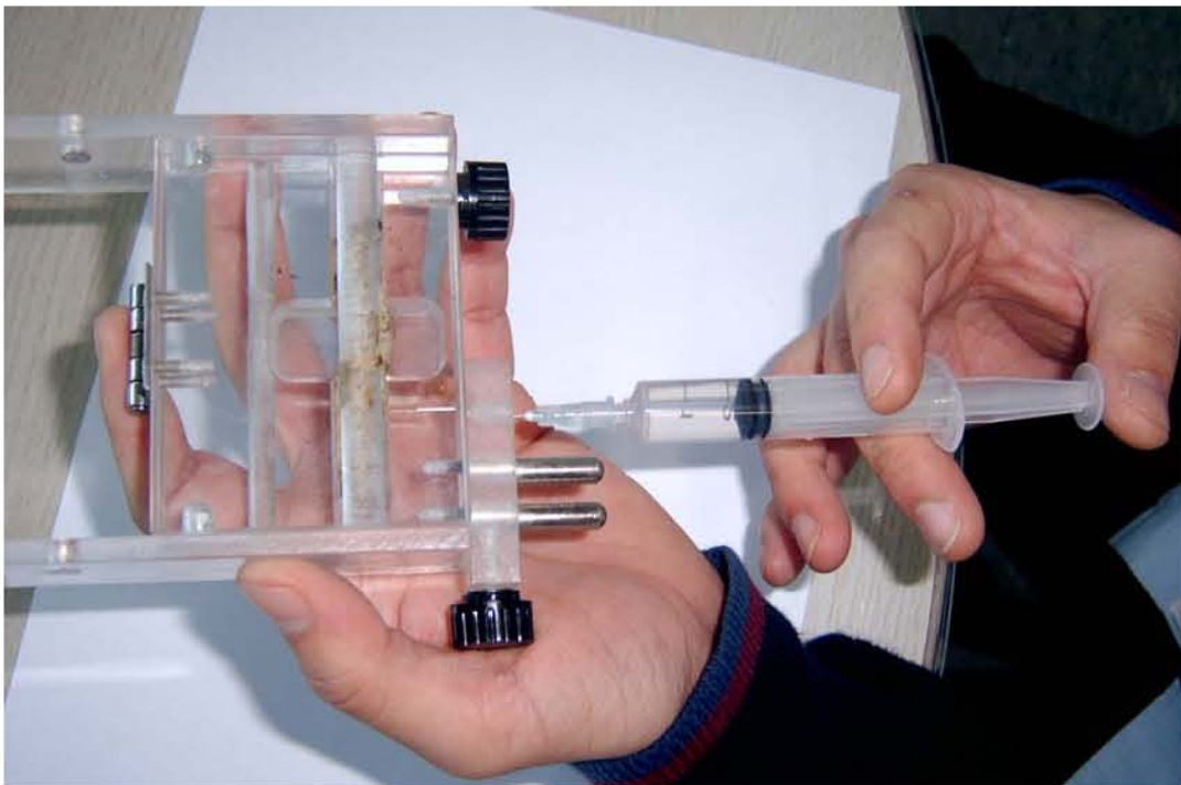
그림 2-6. 2차 간이장치 모델 누에 체강 내 유도액 투입
