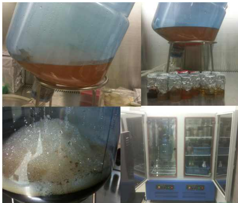
그림 20. Mass culture of lactic acid bacteria using bioreactor
