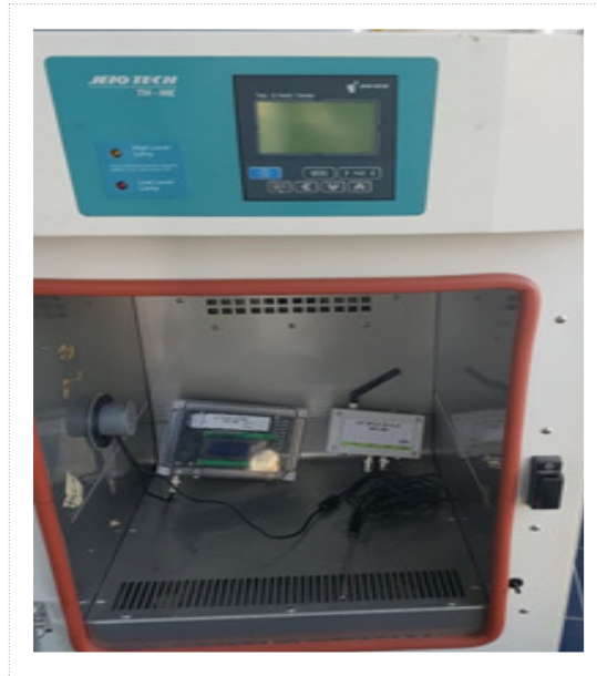
[그림 2-194] 센서 온습도 정확도 유지 실험
