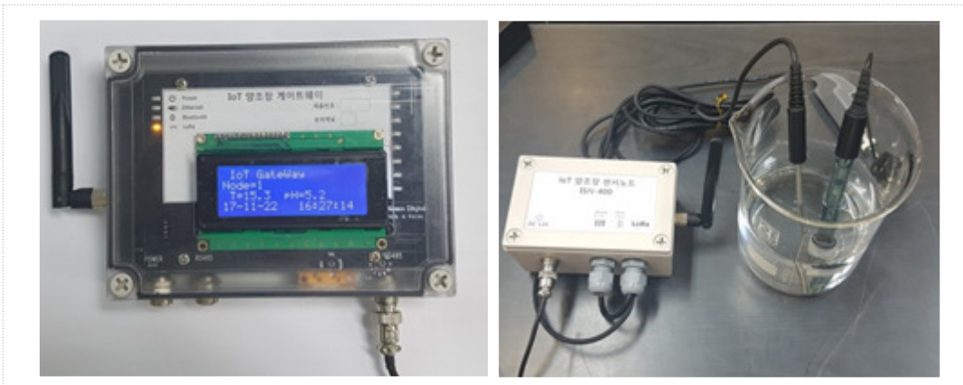
[그림 2-175] 게이트웨이 PC 연결 [그림 2-176] 센서노드 및 연결센서(pH,온도)
