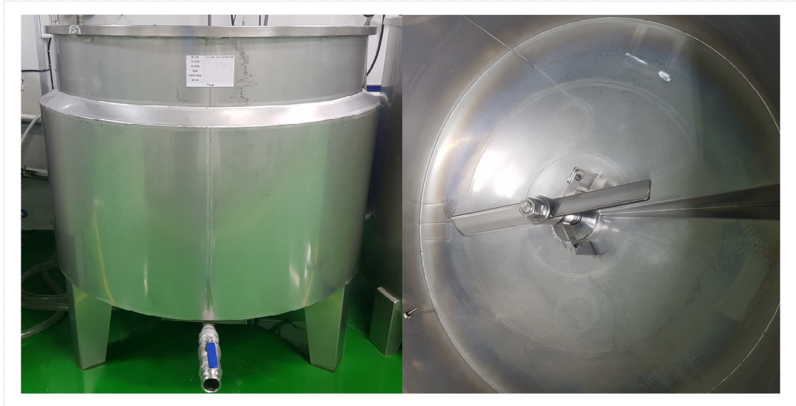
[그림 2-52] 소규모탱크 외관(왼쪽) 내관(오른쪽) 사진
