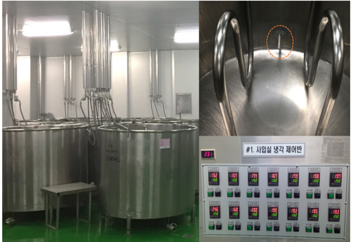
[그림 2-156] 발효 탱크와 컨트롤러 (왼쪽), 발효 탱크 내부의 온도 센서 (오른쪽 위), 온도 센서를 기준으로 발효 탱크의 온도를 제어하기 위한 컨트롤 패널 (오른쪽 아래)
