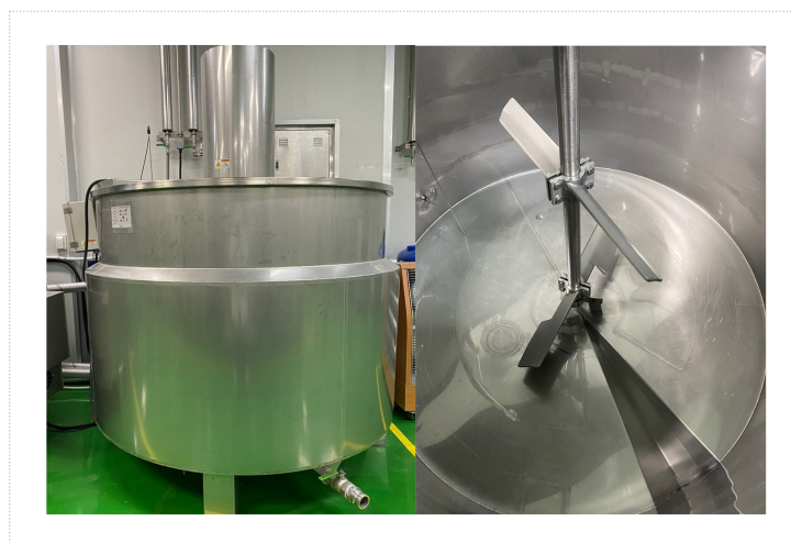
[그림 2-47] 자켓형 탱크 외관(왼쪽) 내관(오른쪽) 사진
