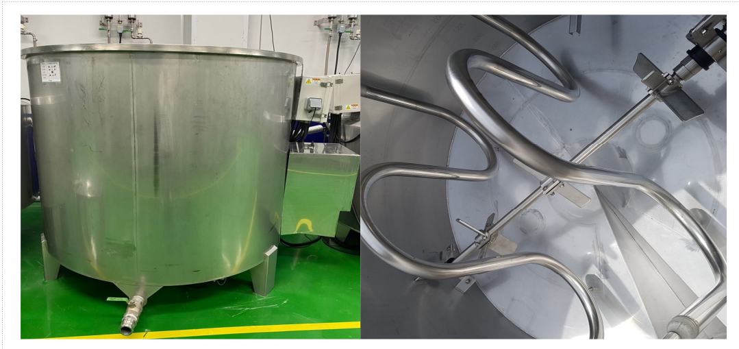
[그림 2-48] 연구과제 홀탱크 추가 측면 소형 교반기 설치 외관(왼쪽) 내관(오른쪽) 사진
