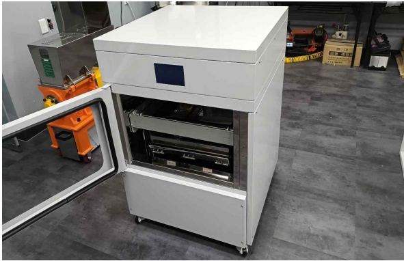
- 전면도어에 강화유리 적용으로 내부 작동 확인 가능
