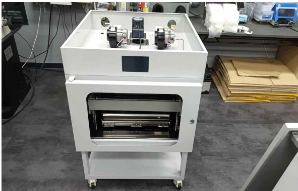
- 전면도어에 강화유리 적용으로 내부 작동 확인 가능
