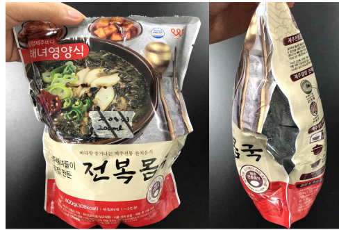
< 식품용 레토르트 팩의 autoclave 결과 >
