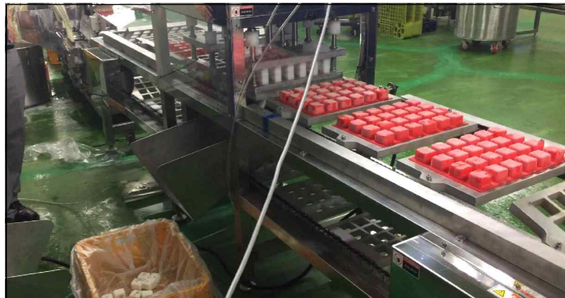
<기정떡을 성형틀에서 자동으로 분리시켜주는 장치>
