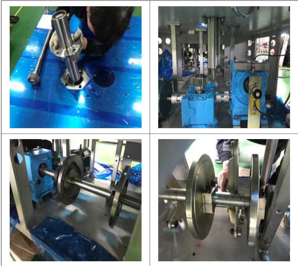
그림 271 Vacuum System 구동축 제작사진
