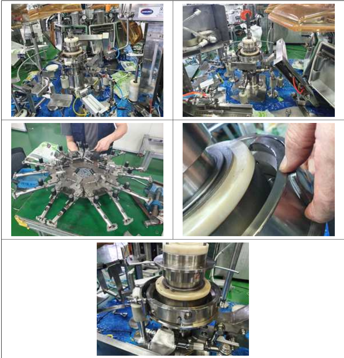
그림 301 Gripper 간격 조절 및 보조장치 보완/수정 사진
