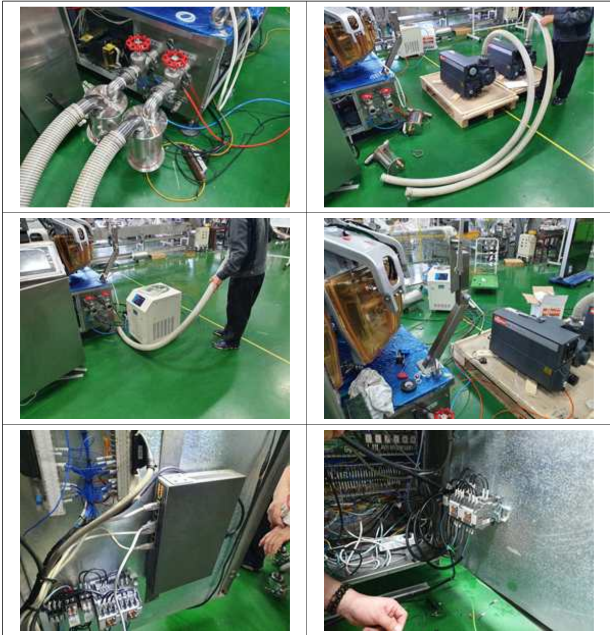
그림 292 진공 발생기 연결, 냉각기/제어 제작사진
