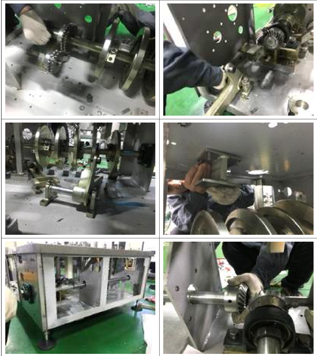
그림 141 Cam 구동축 설치
