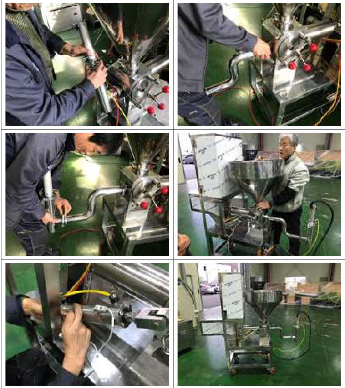
그림 126 충전호퍼 및 간섭방지를 위한 연장 Pipe 설치
