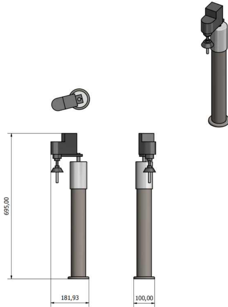
그림 55 Pouch Cleaner Unit의 3D 설계도면
