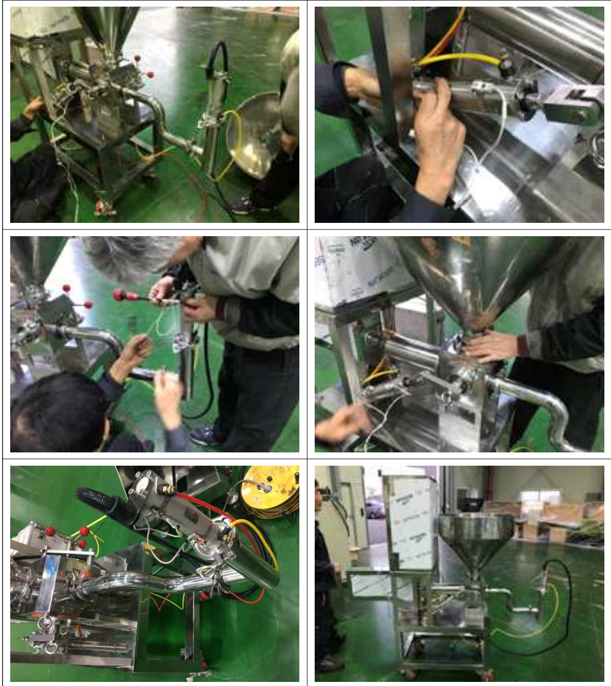
그림 136 서보모터 및 에어실린더 Sensor작업
