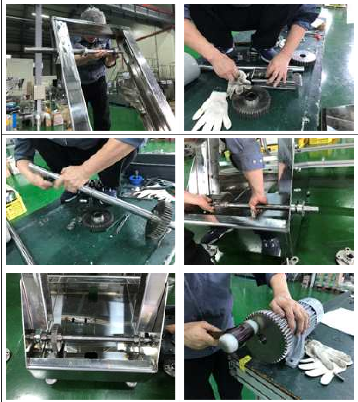
그림 120 Main Shaft 및 Tension Shaft 설치
