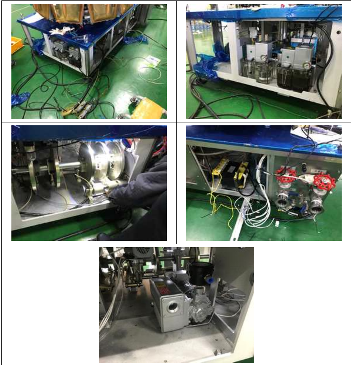
그림 288 윤활유 공급 장치 및 라인 제작사진
