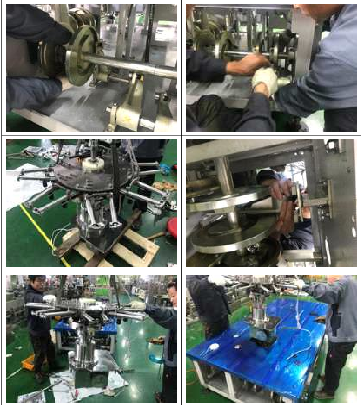
그림 147 메인 구동 축-Gripper Frame 조립 작업
