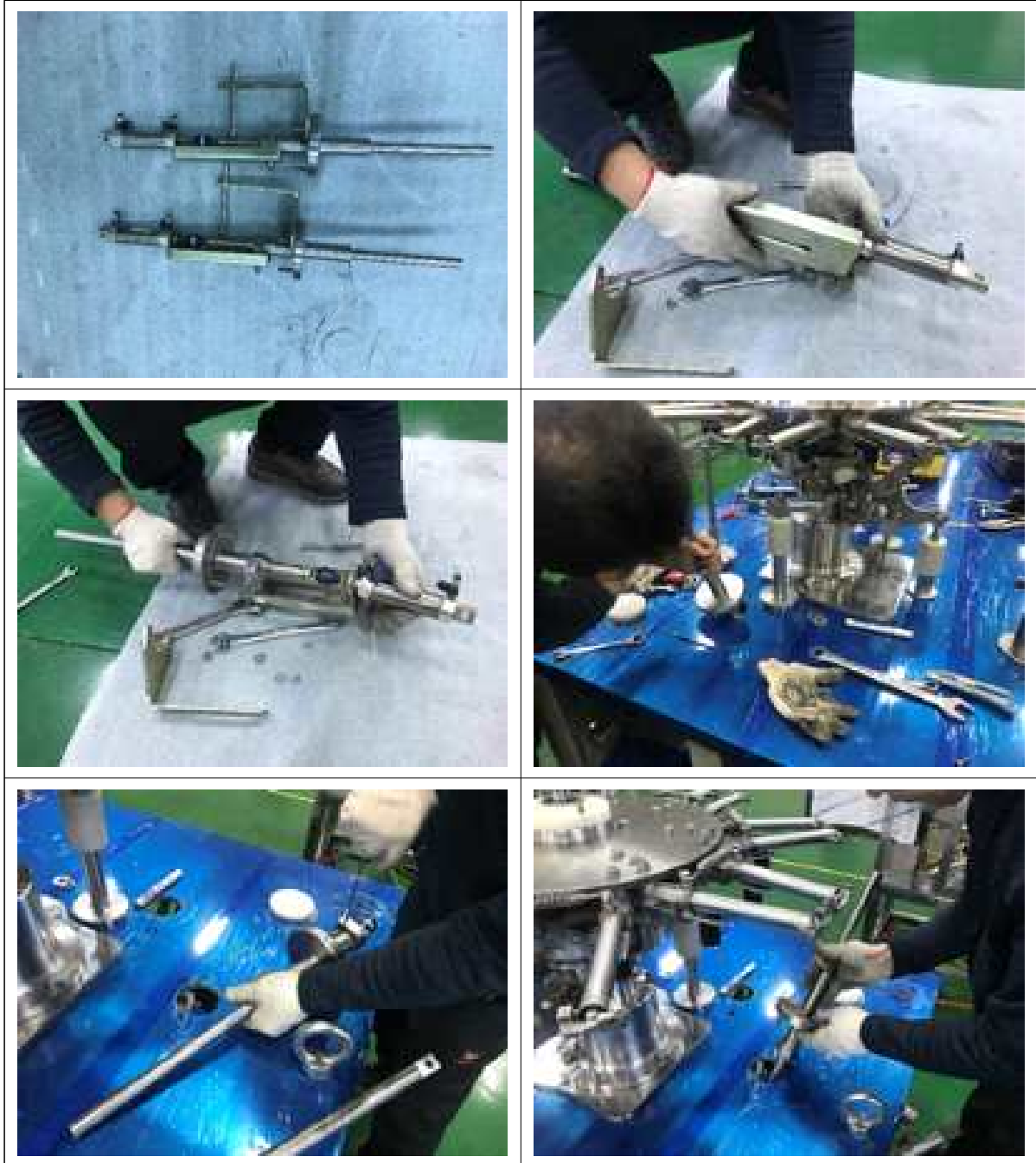
그림 151 셰틀러 장치 조립 및 설치
