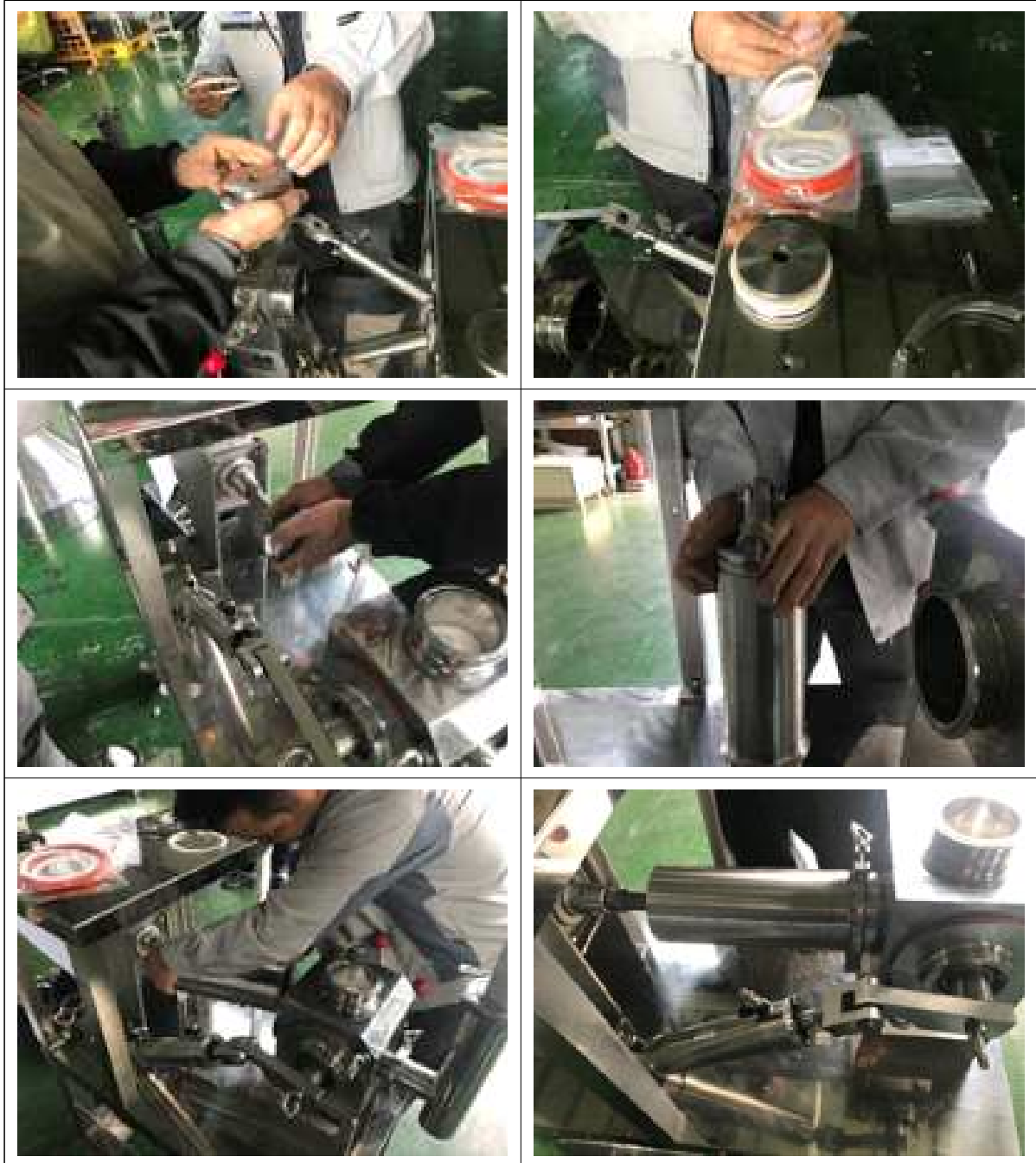
그림 125 개스킷 설치 및 액추에이터 조립
