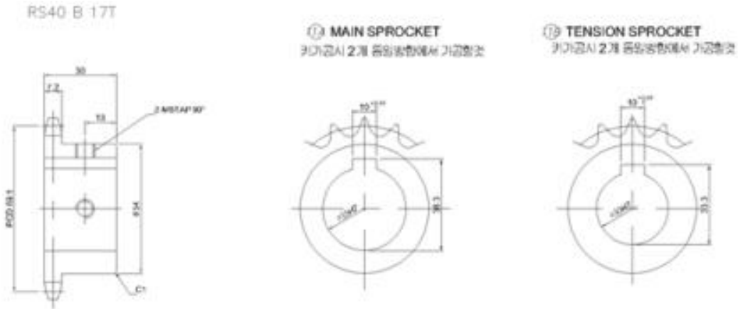
그림 30 Bucket Lift Gear의 2D 설계도면
