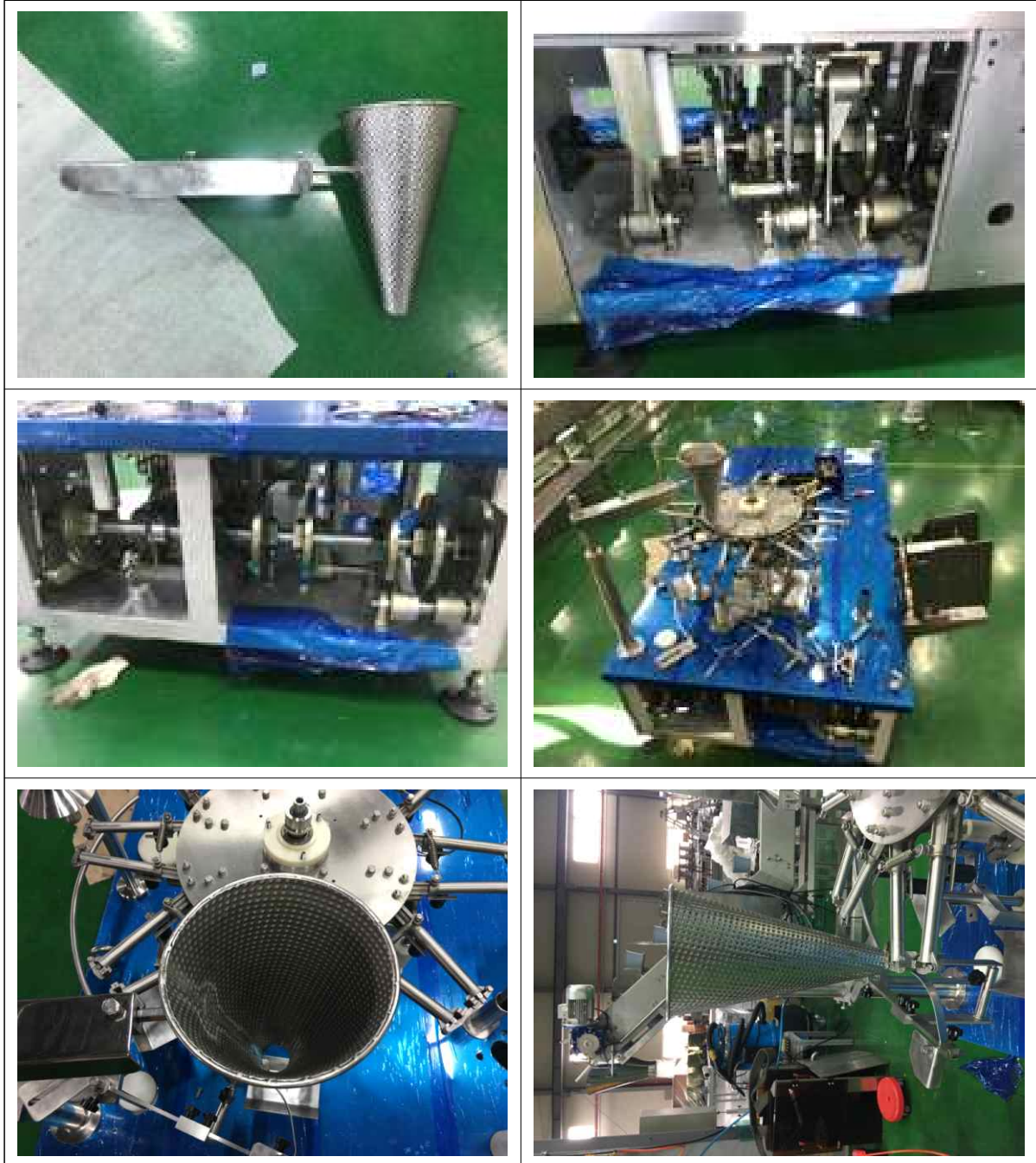
그림 154 내용물 충전 Hopper 설치
