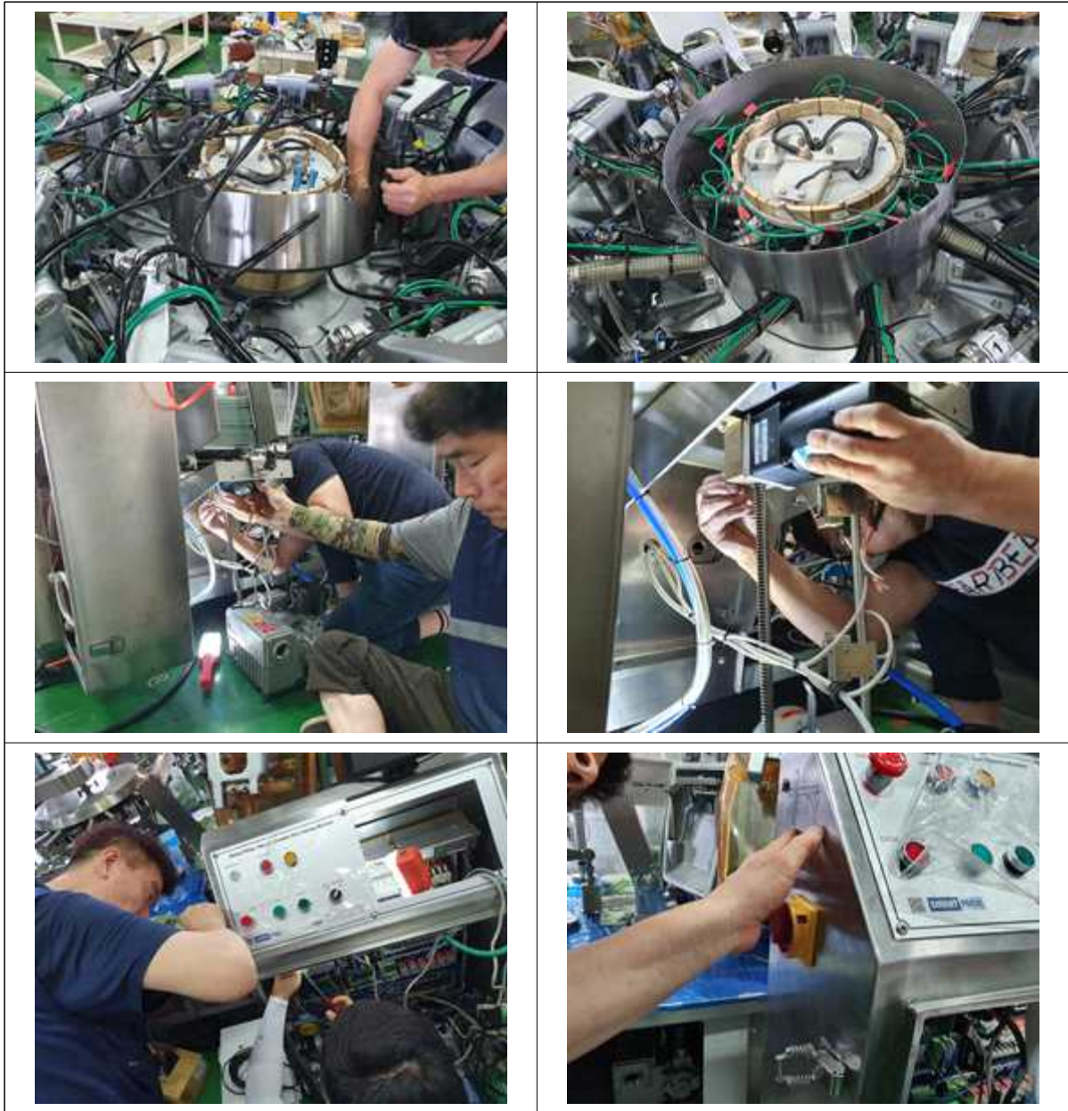
그림 291 Chamber 회전축 커버 및 Pouch 위치 조절 모터 교체 제작사진
