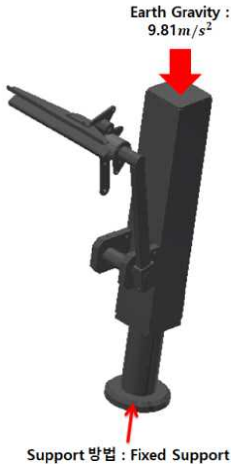
그림 71 Pouch Supply Unit의 하중 및 경계조건
