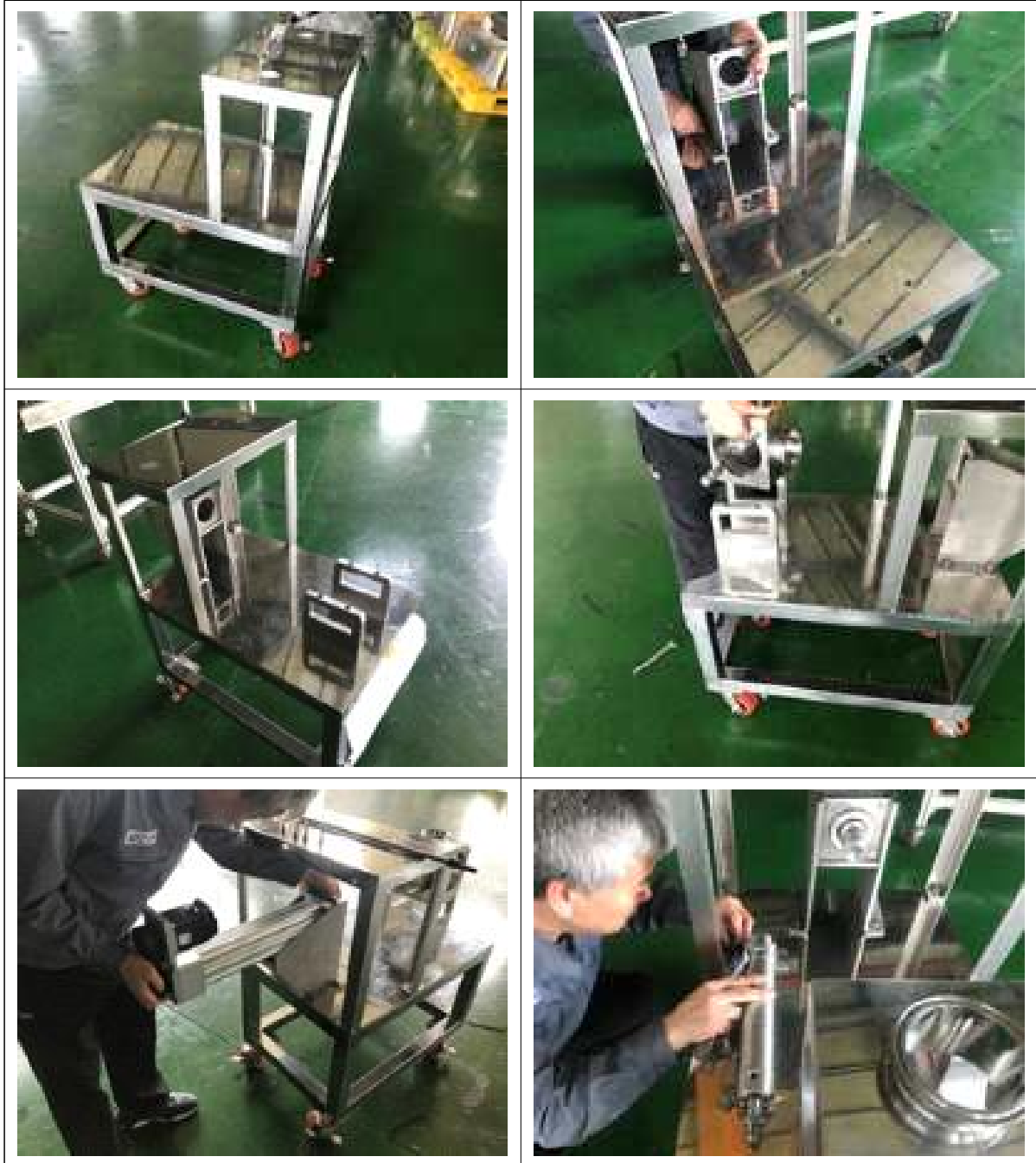
그림 122 Filling Unit Frame 조립
