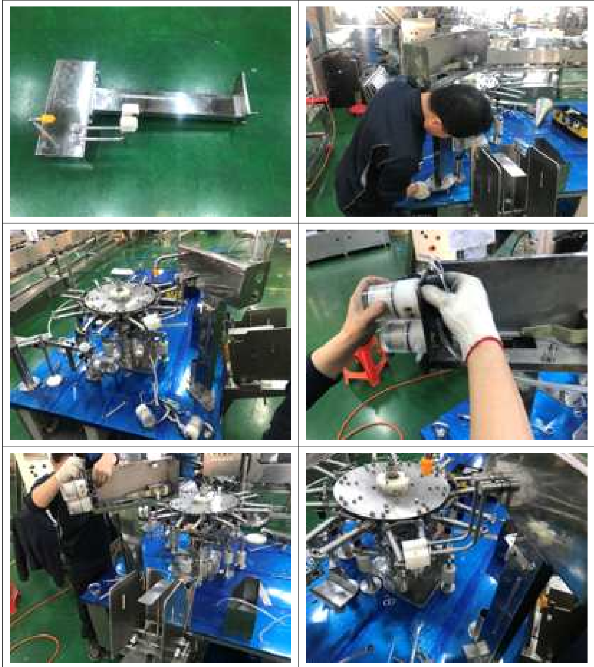
그림 159 Pouch Opener Unit 설치
