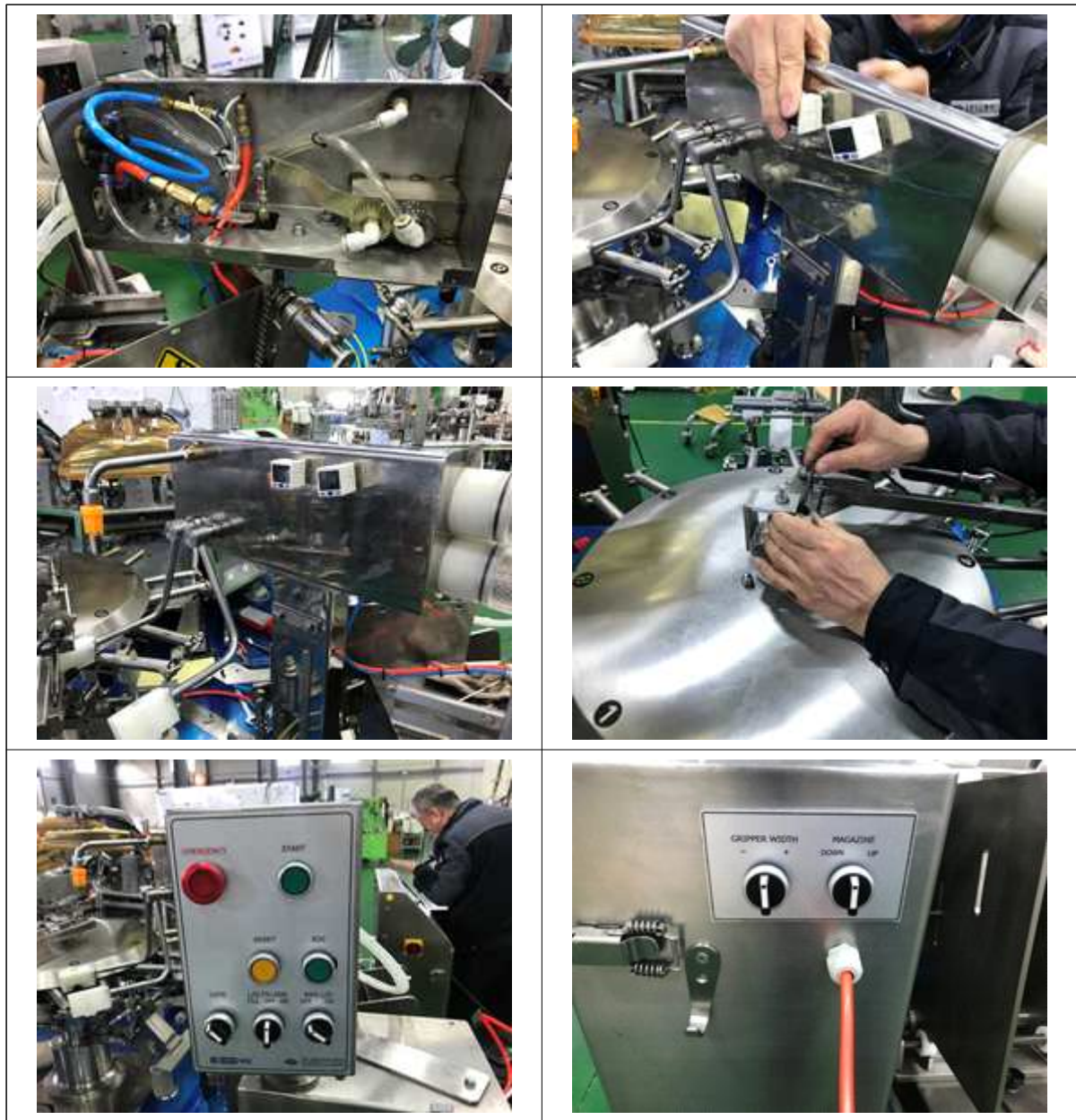
그림 287 Opening Blade 및 센서 부착 사진
