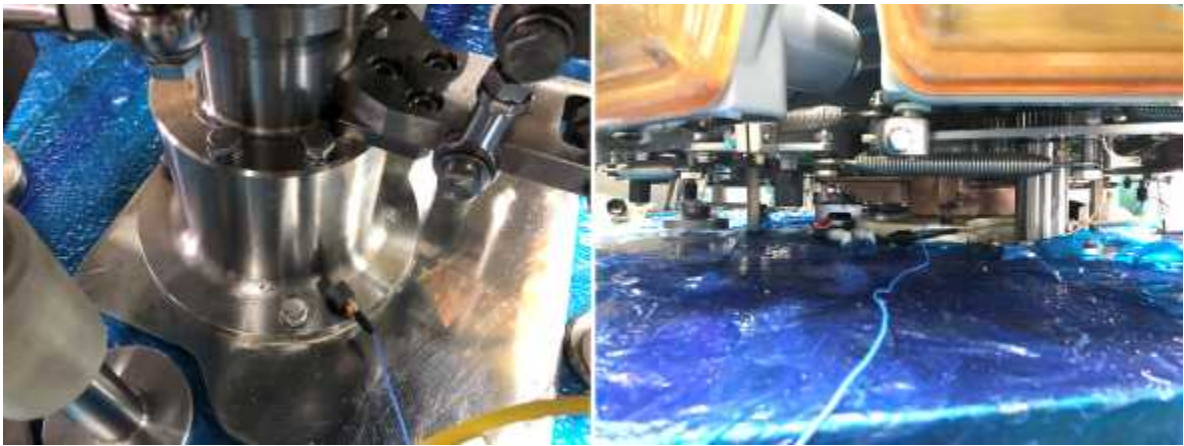
그림 208 가속도 센서 부착 위치
