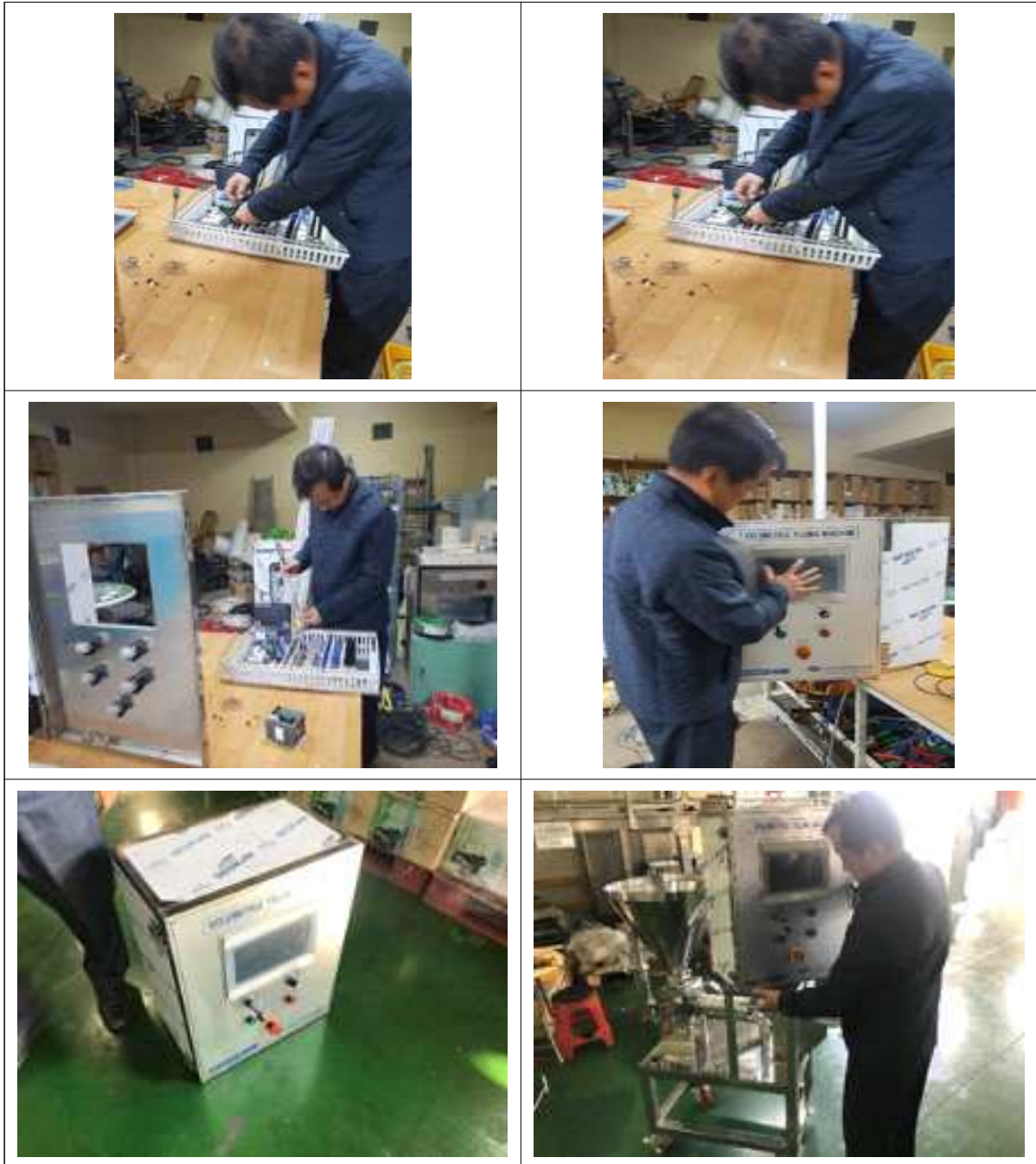
그림 127 Filling Unit HMI(Human Machine Interface) 부착
