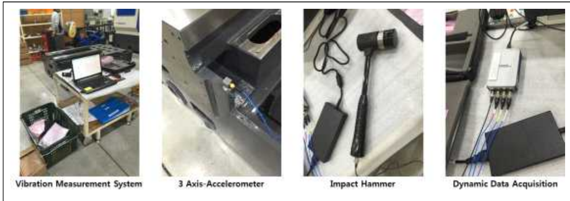
그림 200 진동 측정 시스템 구성
