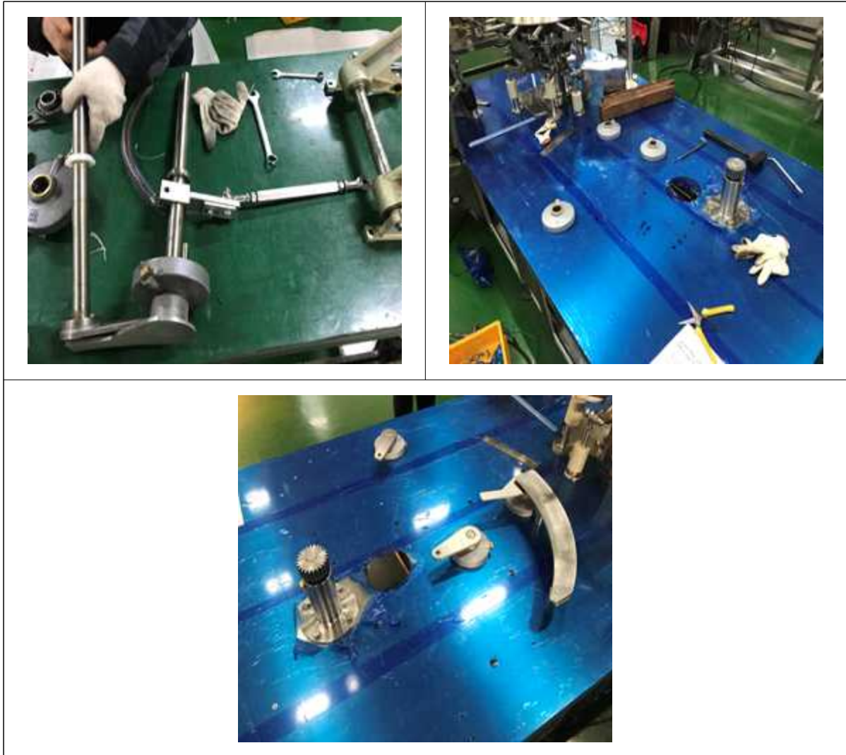
그림 272 Pouch Transfer 구동축 제작사진
