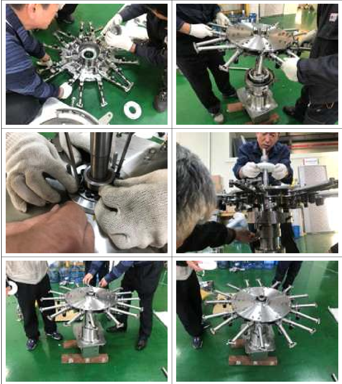
그림 146 Main Shaft 및 Gripper 연동 조립 작업
