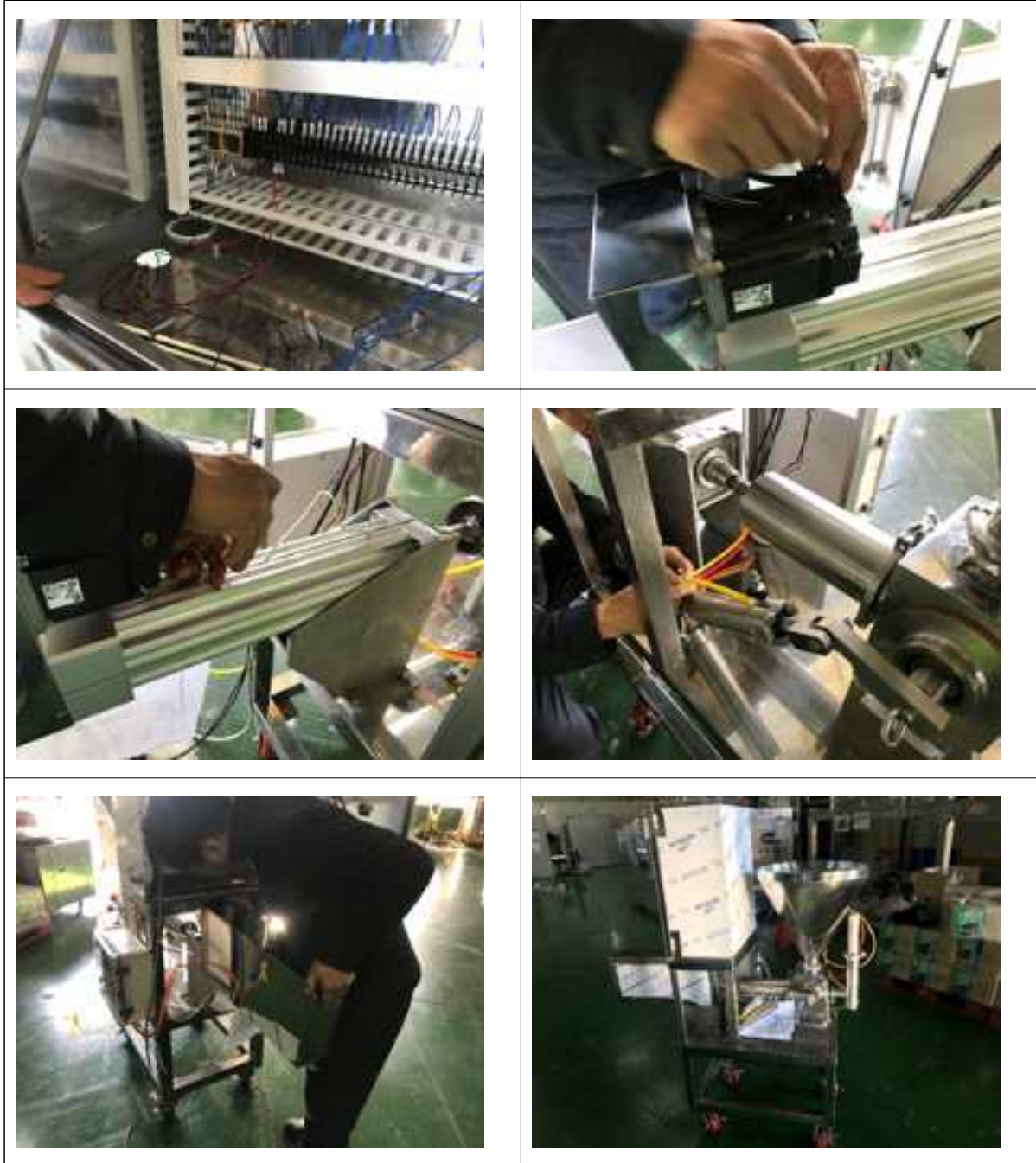
그림 129 Filling Unit 서보 및 액추에이터 설치
