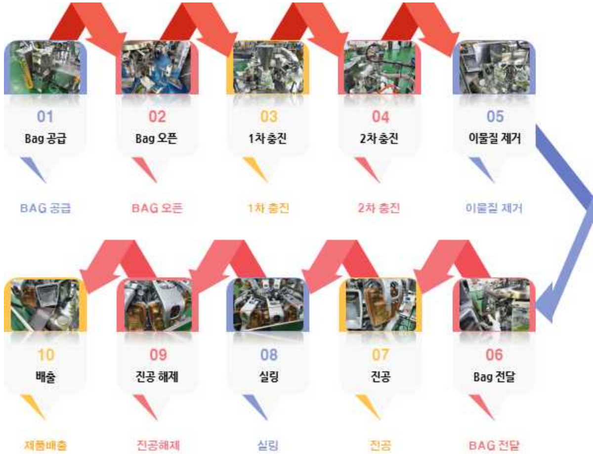
그림 310 Auto Packaging Machine 공정 순서도
