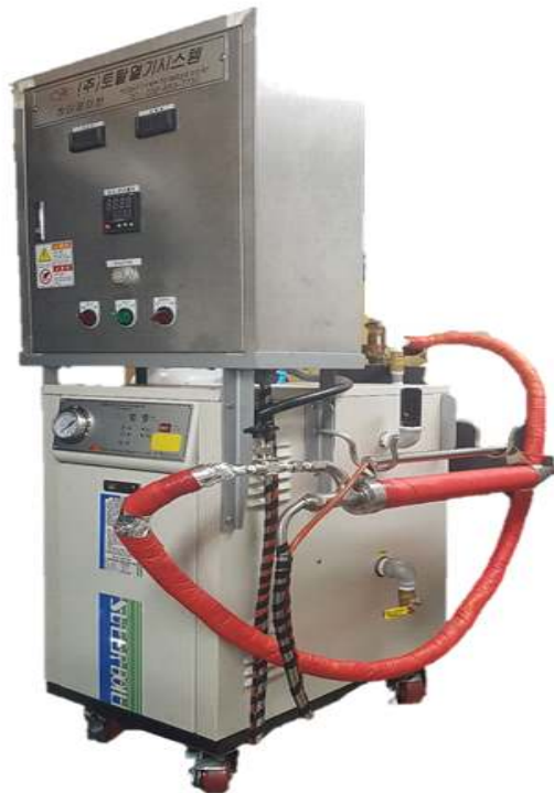
그림 144. 2차 현장형 초고온 과열 증기 발생 장치 사진
