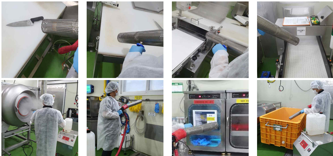
그림 128. 가공식품제조업체 초고온 가열 증기 발생 장치 처리
