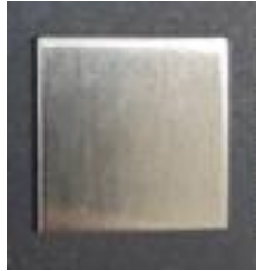
그림 64. 실험에 사용된 SS No.4 coupon (2*2 cm)
