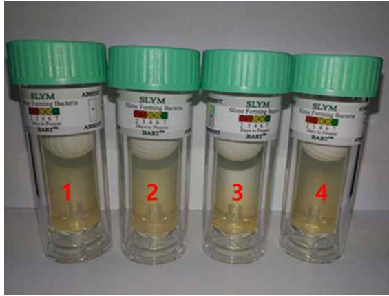
그림 37. SYLM BART를 활용한 biofilm 형성 가능 균주 확인 (띠 형태의 Biofilm(2번, 3번) 탁한형태의 Biofilm(1번, 4번))
