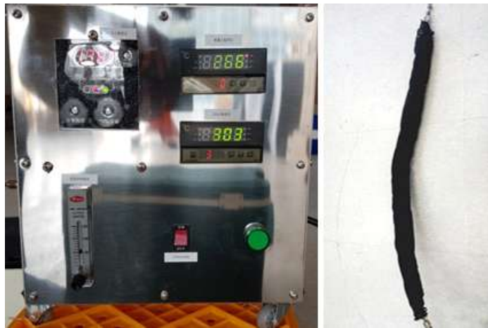
그림 138. 1차 현장형 초고온 과열 증기 발생 장비 시제품 및 발열 호스
