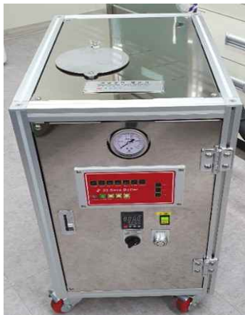
3차 현장형 초고온 과열 증기 발생 장비 전경
