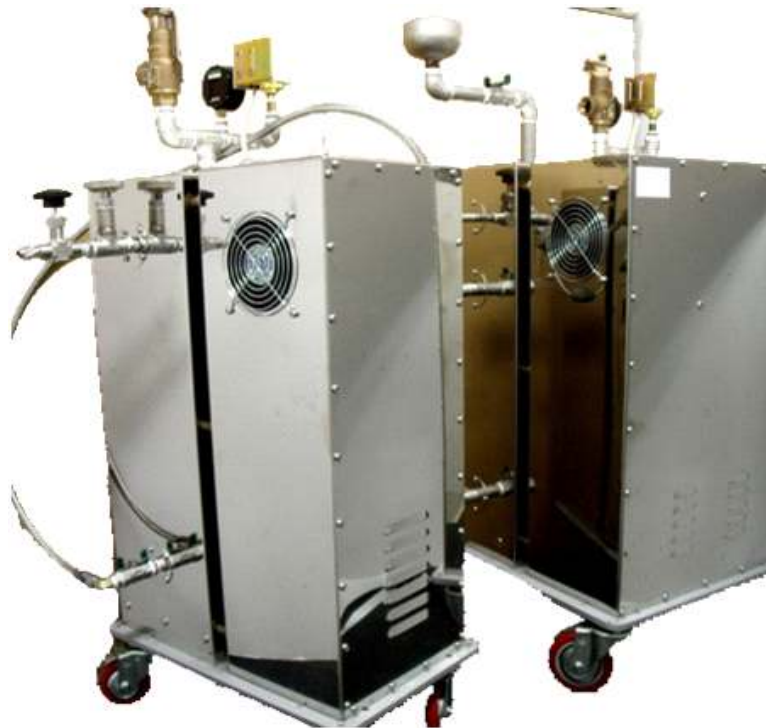
그림 26. 본 실험에 사용된 lab scale 초고온 과열 증기 발생 장비
