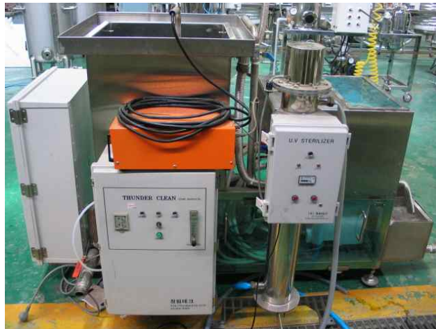
사진 12. 마이크로버블 세척기 및 복합처리 통합시스템 설치
