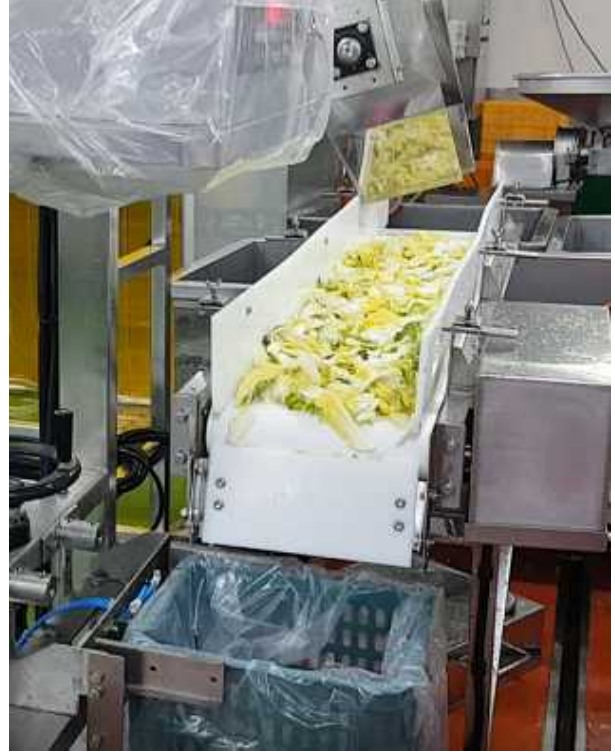
막김치 연속 혼합 포장 장치: 배합기, 벨트호퍼, 금속검출기, 개량 포장 장치로 구성됨
