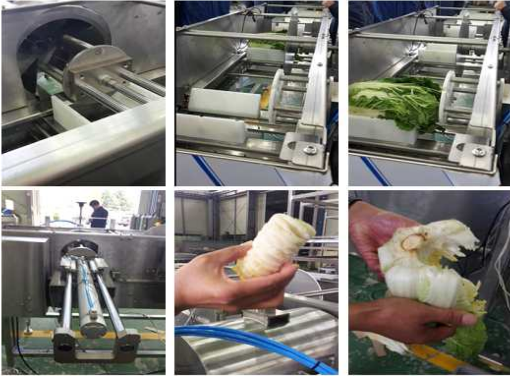
Fig. 2-40. 배추 부위별 절단 장치 시운전
