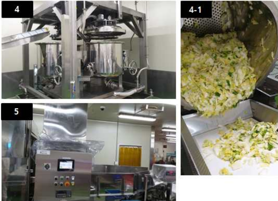
Fig. 1-5. 밀폐순환 가압연속절임기 및 연속 혼합기 라인 4: 밀폐순환 가압연속절임기, 4-1: 절임배추 쏘기, 5: 연속 혼합기 라인
