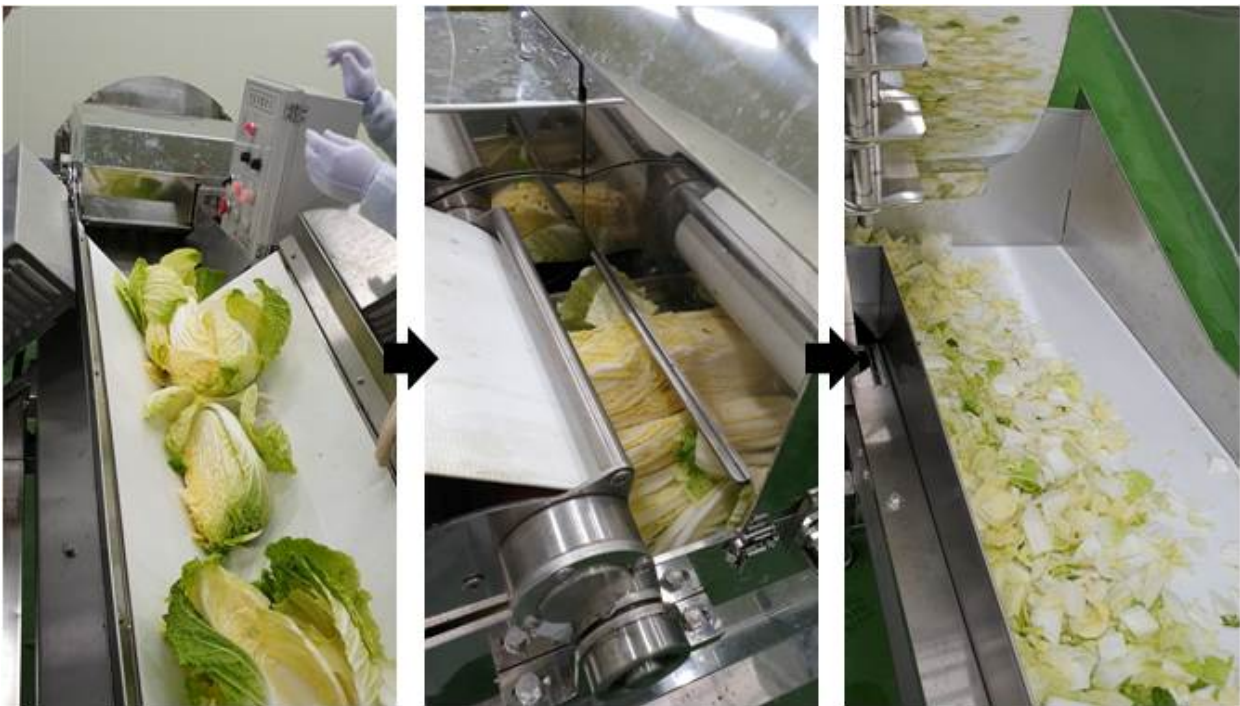
배추 세절기: 배추 부위별 절단기를 통해 고갱이가 제거되고, 3절된 배추가 V자 컨베이어 벨트를 지나 2열 7개의 칼날을 통과하며 곱절이 형태와 같이 길게 절단되며, 마지막으로 회전칼날부를 통과하며 막김치 형태로 절단됨
