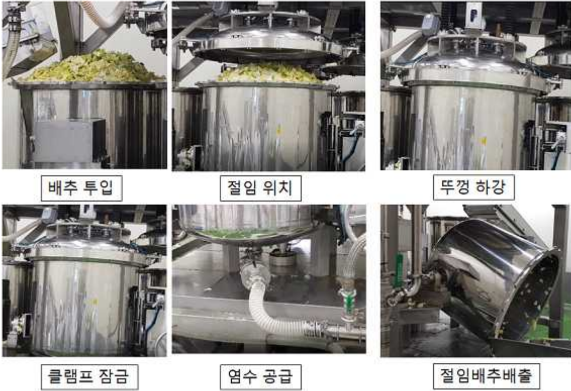
Fig. 3-126. 배추 연속 가압 절임 테스트
