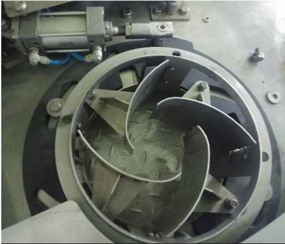
Fig. 3-71. 배추 홀더 장치
