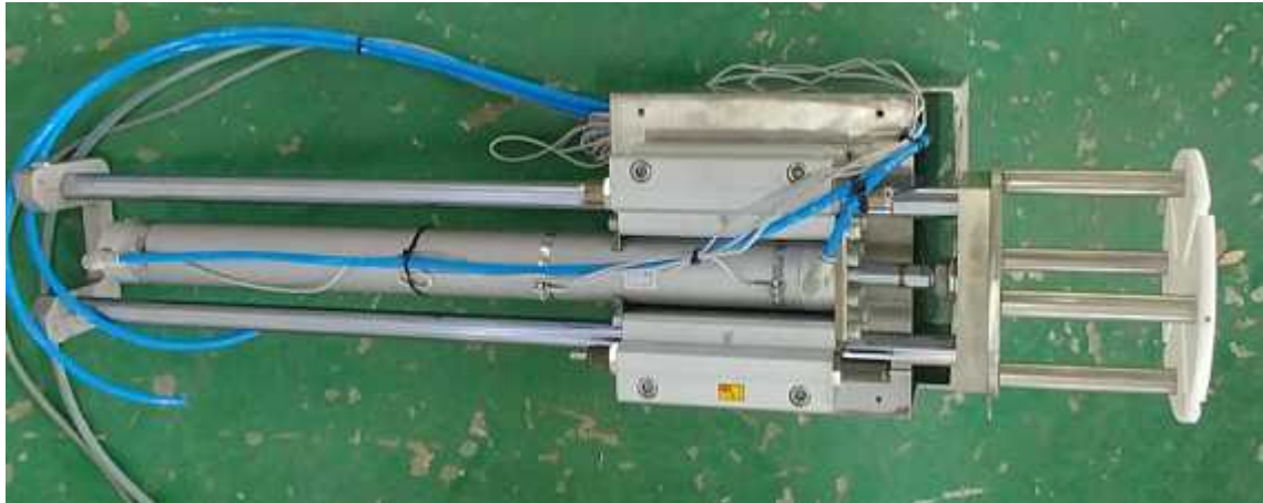
Fig. 3-46. 부위별 절단기 제작 사진-3 배추 푸셔 실린더 장치
