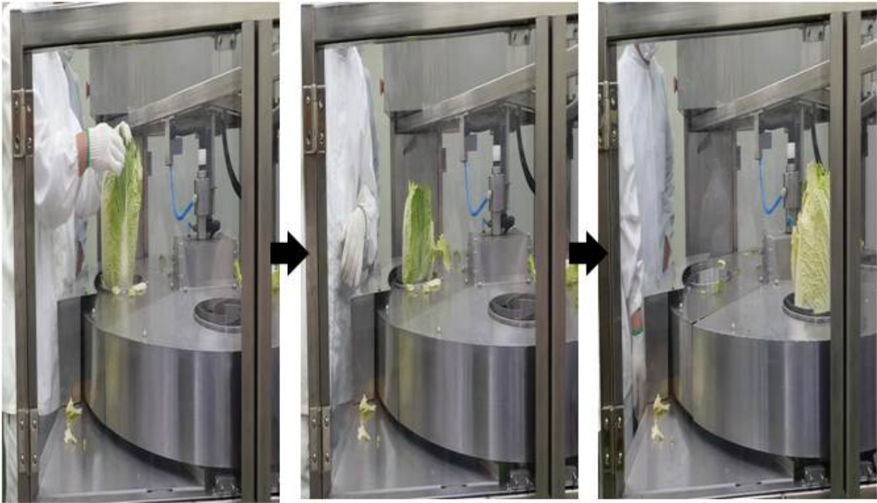
배추 부위별 절단기: 배추를 홀더 장치에 고정시킨 후, 테이블이 회전하면 내부의 단축경 절단기가 단축경부분을 절단하며, 다시 테이블이 회전하면 삼절 칼날부가 배추를 3절하는 방식으로 부위별 절단이 이루어짐
