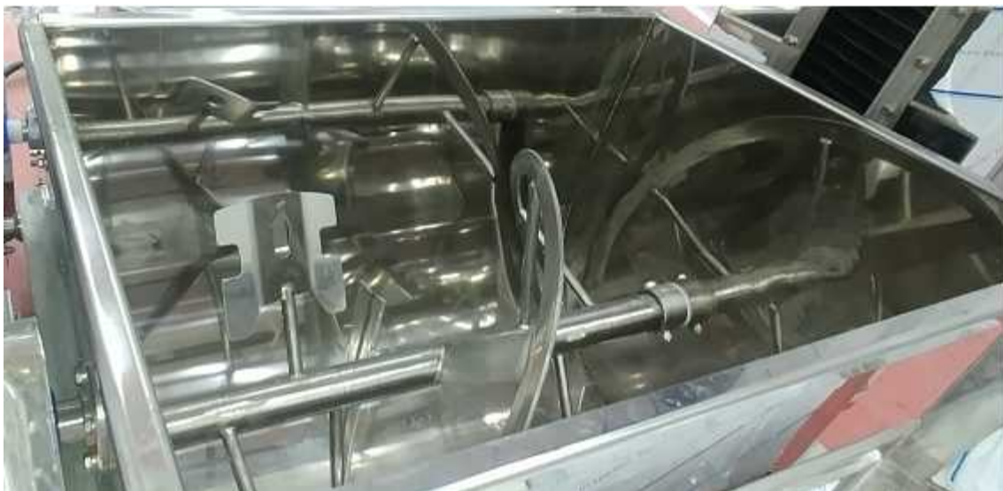
Fig. 3-133. 혼합기 내부 교반 날개 모양
