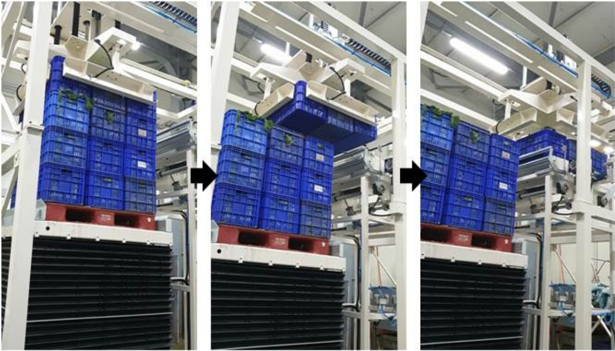
상자 분리 장치: 1단(2*3형태, 6상자)씩 상자 한줄 공급 장치로 이동
