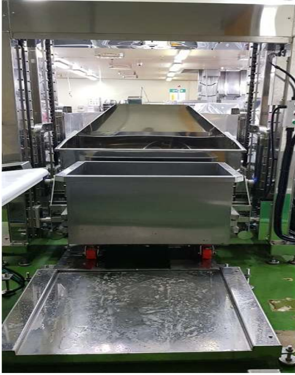
막김치 연속 혼합 포장 장치: 배합기, 벨트호퍼, 금속검출기, 개량 포장 장치로 구성됨
