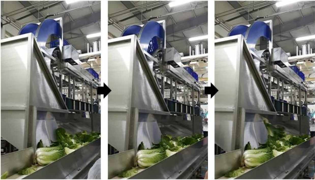
배추 솟기 장치: 상자 한줄 공급 장치에서 공급된 상자를 컨베이어에 의해 뒤집는 방식으로 배추를 솟음. 솟아진 배추는 컨베이어를 통해 절단 라인으로 이동
