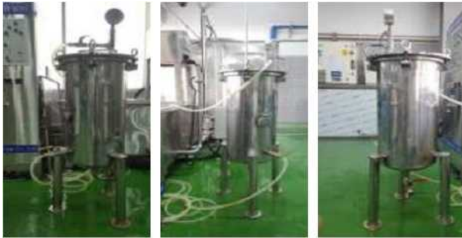
Fig. 2-58. 막김치 가압 연속 절임장치 시작품(전면부, 우측, 좌측)
