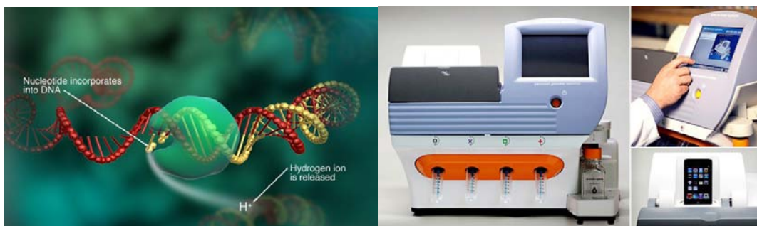
그림. 2 pH변화를 이용한 새로운 방식의 NGS machine
