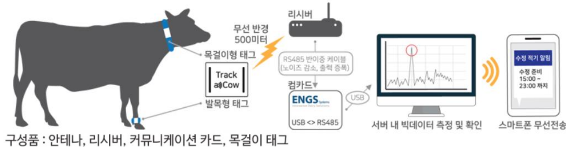
그림 ▶ 발정탐지기(파우스 시스템) 구성
