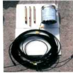
2) 센서, RTU 전원공급장치, 케이블 준비
