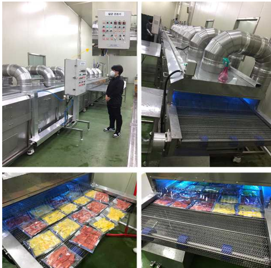
그림1. 신선한 절단 파프리카의 자동 스마트 식품가공시스템(UV-C 처리기기의 설치)
