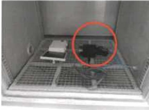
그림 2) 방진시험 설치사진
