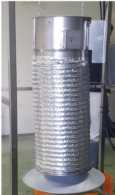
그림 81 수직 교반 구조의 면상 발열 히터(4kW) 시제품
