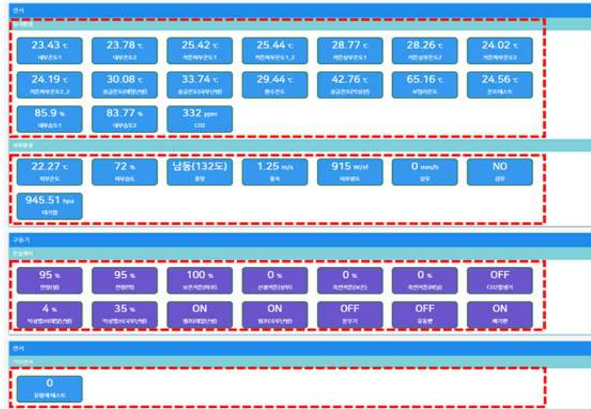
그림 16. 온실통합제어기/구역 별 센서/액추에이터 정보 조회결과 확인
