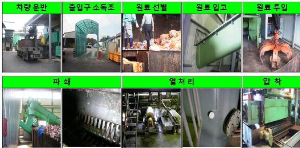
그림 61. 폐사가축의 렌더링 처리과정 (출처 : 친환경적 가축사체처리 시스템 구축 전략, 2014, 한국연구재단)
