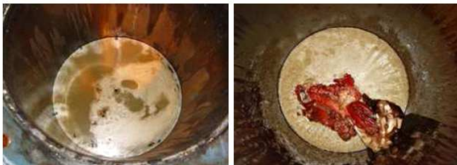
그림 62. 폐사가축의 알칼리 가수분해 (출처 : 친환경적 가축사체처리 시스템 구축 전략, 2014, 한국연구재단)
