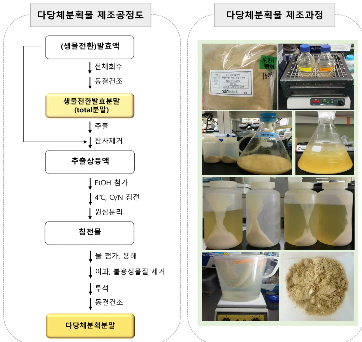
그림 128. 다당체분획물 제조공정도 및 제조과정
