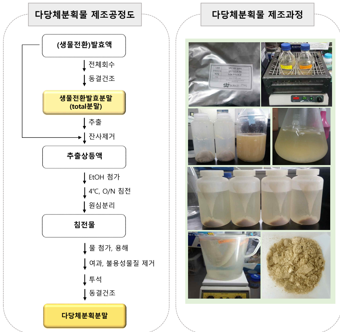
그림 135. 다당체분획물 제조과정도 및 제조과정
