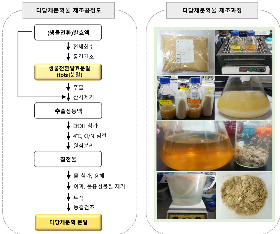
그림 121. 다당체분획물 제조공정도 및 제조과정
