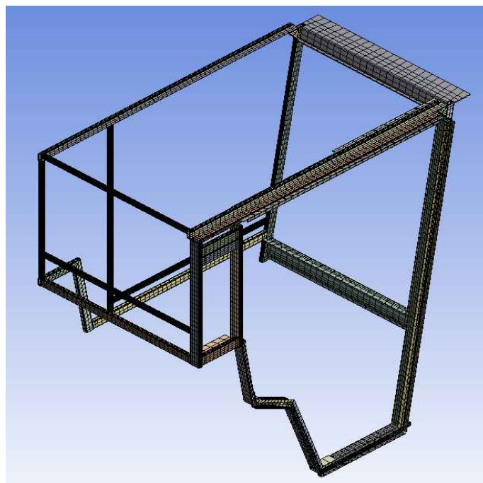
그림 3-104 변경 프레임의 모델 설계.
