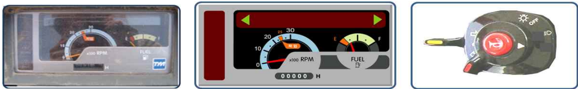
그림 3-91 인간공학원리를 적용한 계기판 및 혼/부저/정지버튼.
