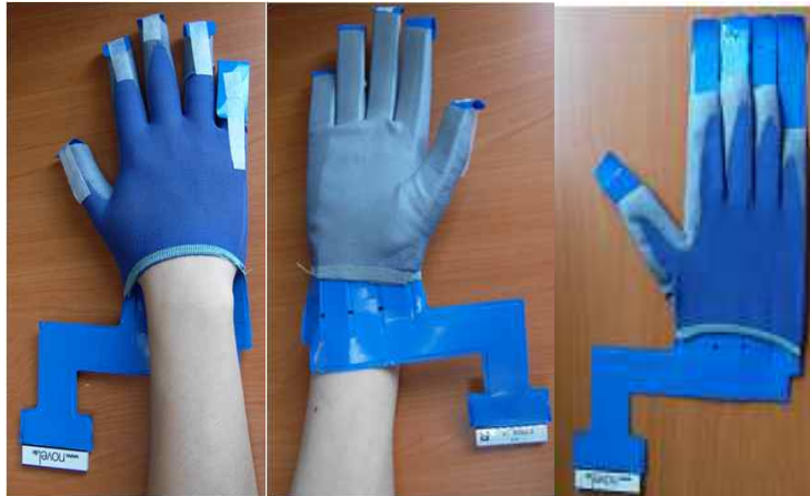
그림 3-210 실험에 사용한 손압력 센서 및 장착 모습.
