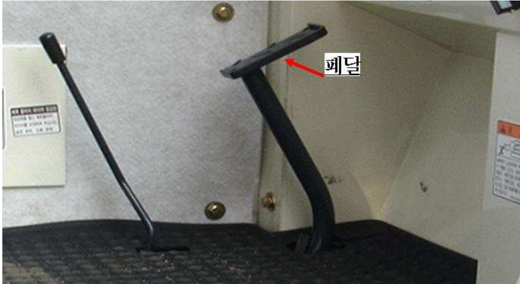
그림 3-227 콤바인 브레이크 페달의 조작력 측정.
