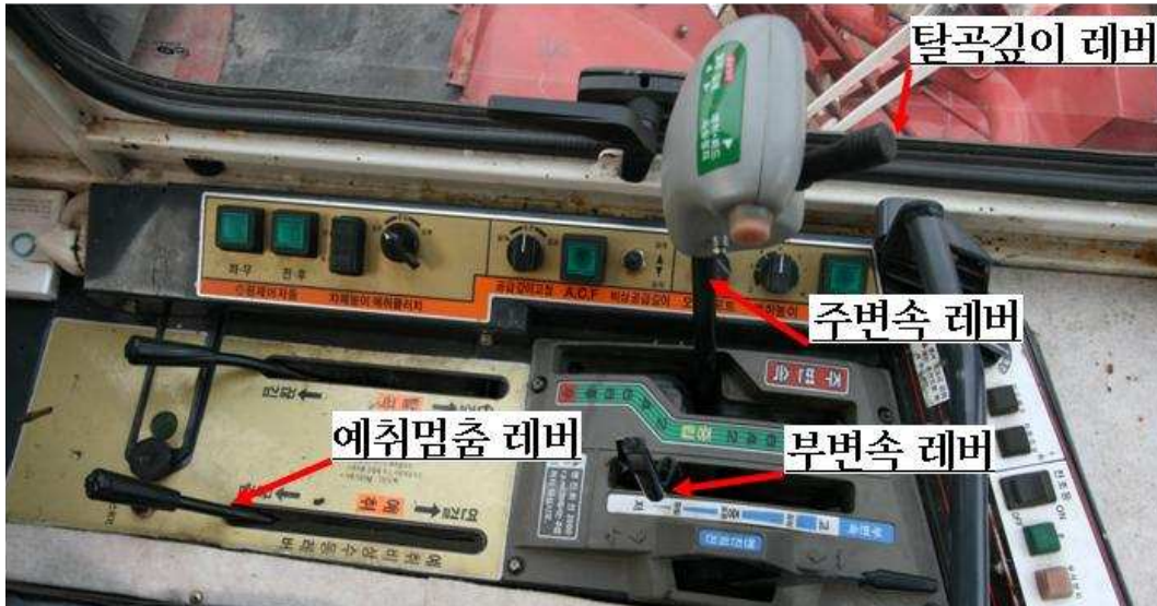
그림 3-225 예취, 탈곡, 변속 레버의 조작력 측정.
