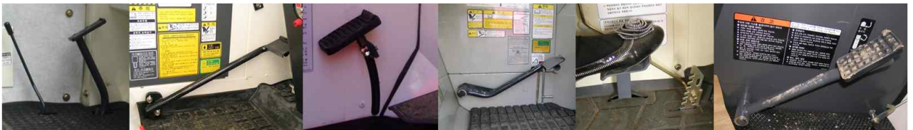
(a) 국내 T社 (b) 국내 K社 (c) 국외 K社 (d) 국외 Y社 (e) 국내 D社 (f) 국외 M社 그림 3-17 콤바인 제조사별 브레이크 페달 비교.
