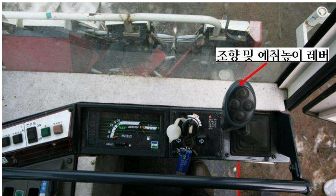
그림 3-226 조향 및 예취높이 레버의 조작력 측정.
