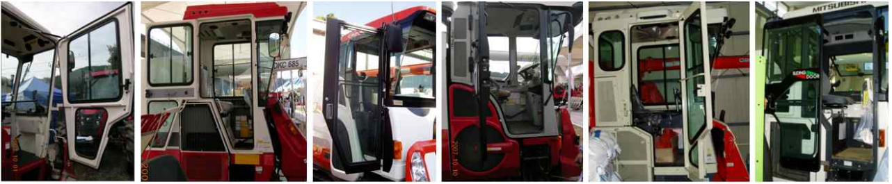
(a) 국내 T社 (b) 국내 K社 (c) 국외 K社 (d) 국외 Y社 (e) 국내 D社 (f) 국외 M社 그림 3-16 콤바인 캐빈의 출입문 개폐 방식 비교.
