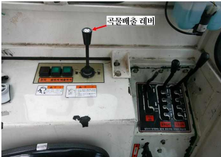
그림 3-224 곡물배출 레버의 조작력 측정.
