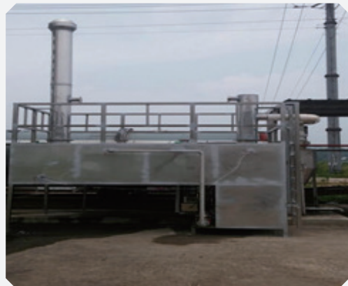
밀폐 수평 원통형 발효기 탈취시스템
