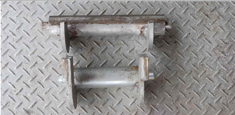
<그림 44> 후구하강레일 교체(2020.07.10.) [(상) 330mm/ (하) 210mm]
