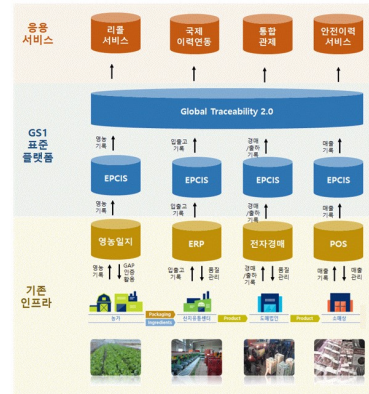
[그림 27] Hybrid 표준시스템에서의 GS1 표준 기반 데이터 소통 채널 구성
