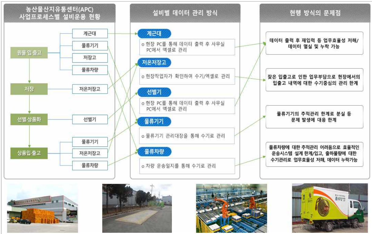
<농산물산지유통센터(APC) 주요 설비구성 내역 및 현행 사업방식의 문제점>
