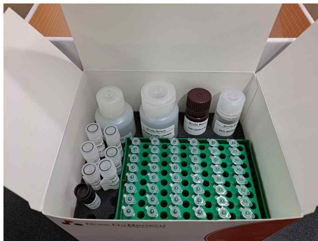
그림 44. Master Mix를 소분하여 동결 건조한 최종 시제품 형태
