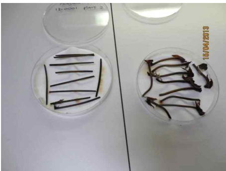
9) 침지한 샘플링한 것은 페트리디쉬에 여과지를 깔고 그 위에 샘플을 넣고 페트리디쉬 뚜껑을 덮고 25°C 항온에서 7일간 둔다.
