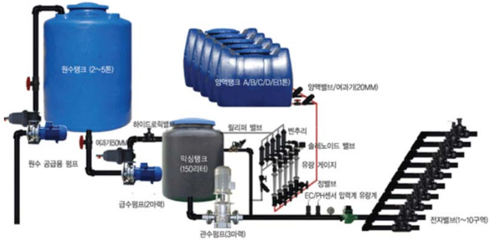
그림 11. 벤추리식 양액·관비시스템 구상도(자료 출처 : 신한에이텍)
