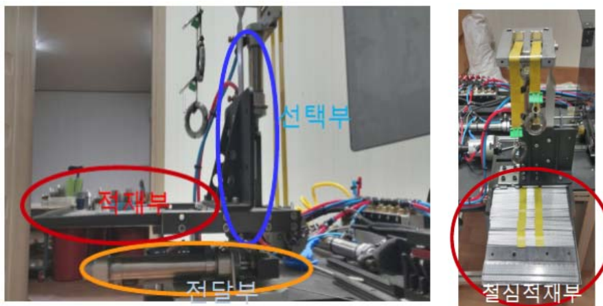
Fig. 5. 지지대 피딩 (feeding) 장치
