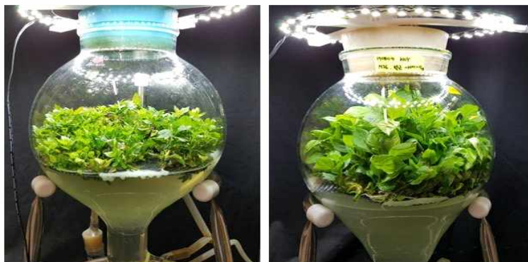
그림. 줄 LED를 이용한 생물반응기용 광조사 시스템[증식용(좌), 발근용(우)].
