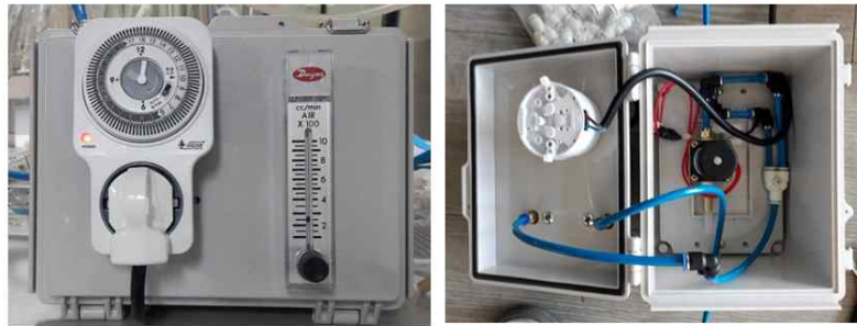
그림. 사과 기내배양용 TIB 시스템에 이용된 타이머와 솔레노이드 밸브.
