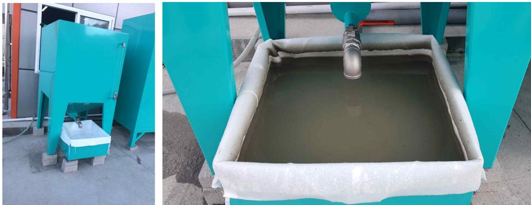
[그림 48] 여과 필터를 이용한 수동식 슬러지 탈수장치(영주거점에 설치 시험)
