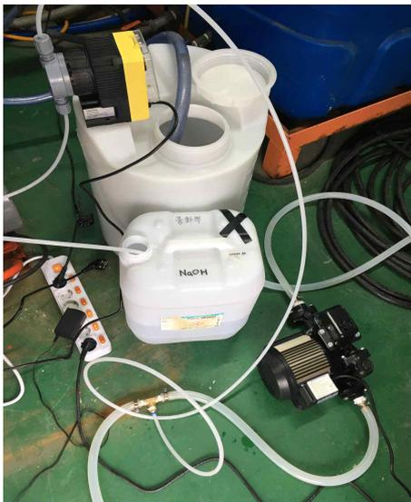
[그림 60] 소독액 중화장치 테스트
