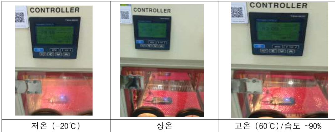
그림 20. 센서노드 온도신뢰성 측정
