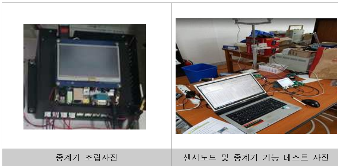
그림 21. 중계기 조립 및 테스트 사진
