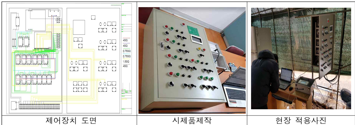
그림 19. 사양제어 컨트롤보드 제작 및 적용 사진
