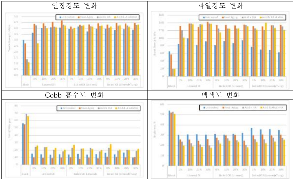
Fig. 3-39. 열노화 및 농약살포 시 오일종류 및 폴리카타놀계 도료 투입비가 배봉지 원지 물성에 미치는 영향
