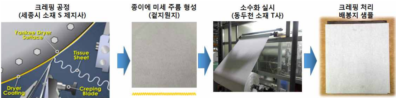
Fig. 1-18. 크레이핑 공정 및 소수화 처리를 거친 겉지를 이용한 크레이핑 처리 배봉지
