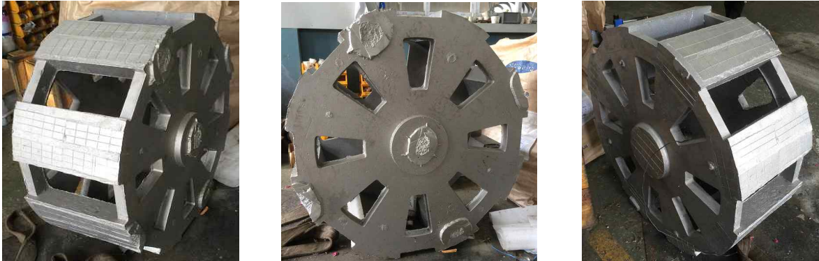
Fig. 2-9. 제대원지의 장력제어 등을 위한 알루미늄합금 재질의 구조설비를 거푸집을 이용하여 주물 생산함으로써 국산화 진행
