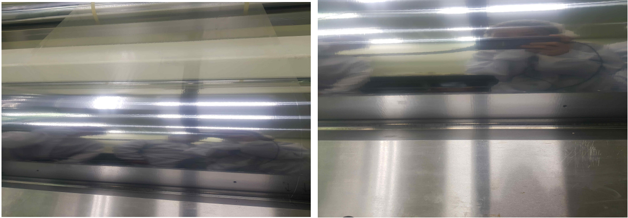
그림 60. levelling 현상 발생한 코팅 작업사진
