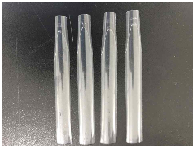
그림 94. PET/1-A/Nylon/LDPE A,B,C 다층 복합 필름의 층간 박리
