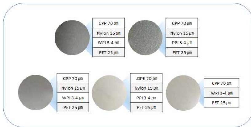
그림 86. 천연코팅제를 적용한 다층필름의 구조 설계
