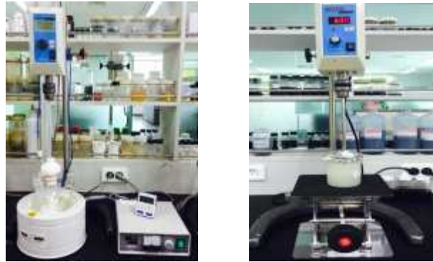
그림 14. 수화반응 시스템; 가열 수화반응(left), 상온 수화반응(right)
