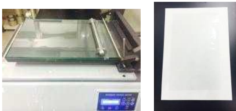
그림 15. 도공기와 applicator를 사용한 코팅 방법(left), 코팅한 필름(right)
