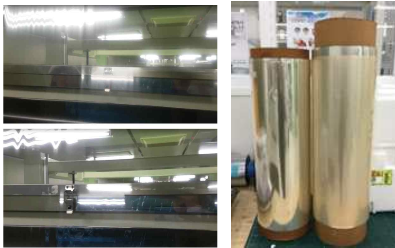
그림 45. 롤투롤 ③방법으로 코팅 작업중인 현장 및 제작 완료된 롤필름
