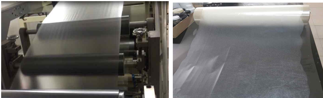
그림 43. 롤투롤 ①방법으로 코팅 작업중인 현장 및 제작 완료된 롤필름
