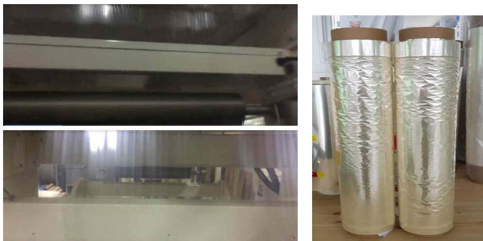
그림 44. 롤투롤 ②방법으로 코팅 작업중인 현장 및 제작 완료된 롤필름
