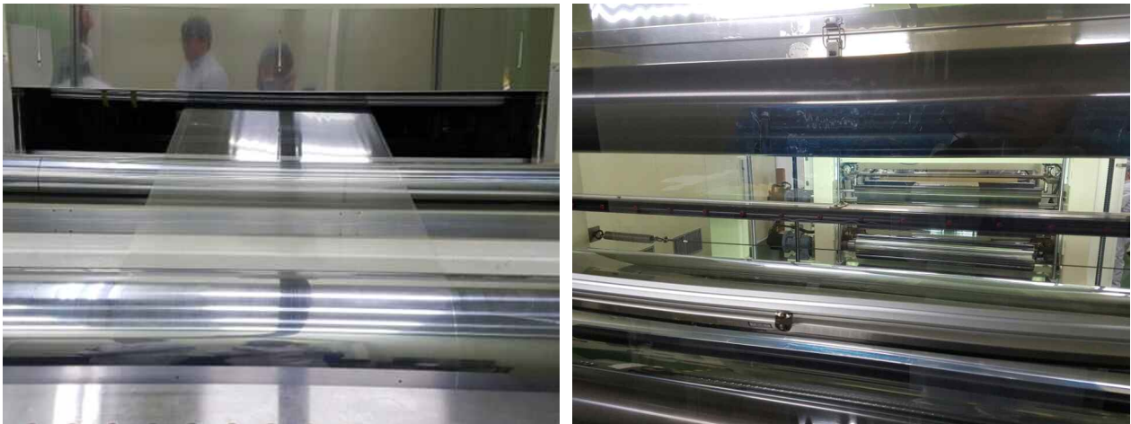
그림 61. levelling 현상 개선한 코팅 작업사진
