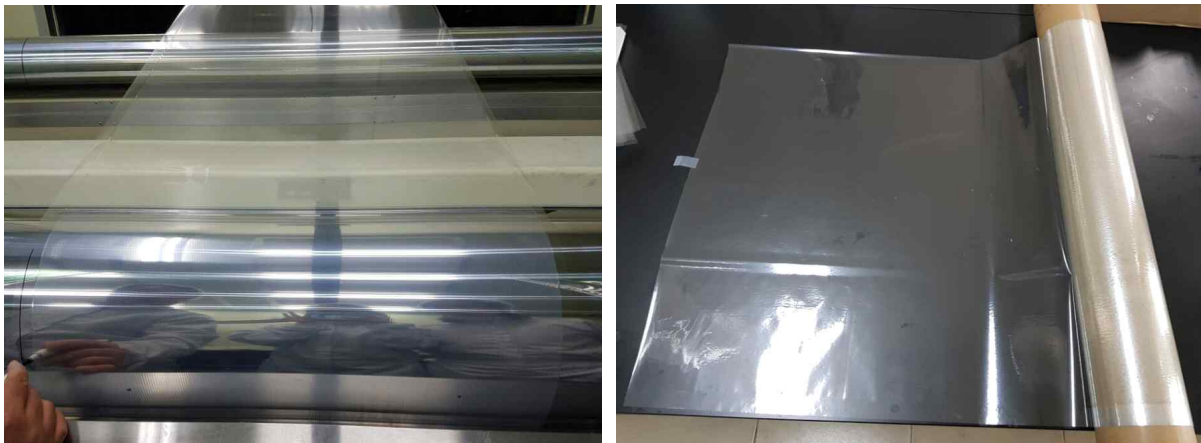
그림 47. 롤투롤 ④방법으로 코팅 작업중인 현장 및 제작 완료된 롤필름(도막두께 조정)
