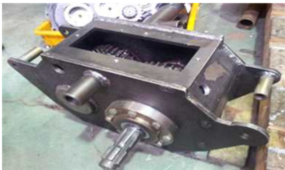
[PTO(좌) 및 PTO 하우징 제작]
