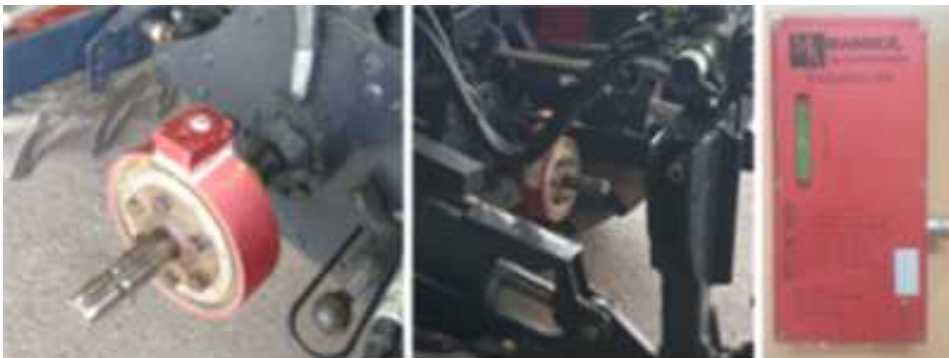
[PTO 토크미터 장착 사진 및 Amplifier]
