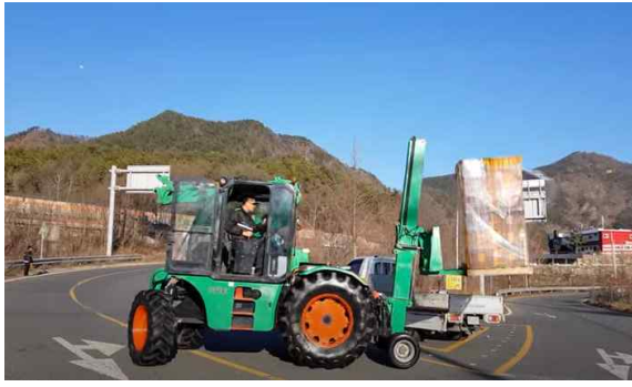
[텔레스코픽 암을 이용한 상·하차 테스트]
