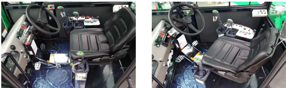
[운전석 회전시스템 전방 0°(좌), 전방 45°(우)]
