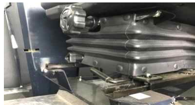
[쿠션 조절 및 경고음 조절 레벨(좌), 운전석 완충 쿠션장치(중), 운전석 회전판(우)]
