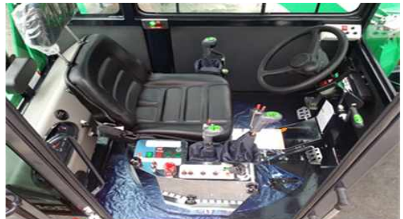
[운전석 회전시스템 후방 135°(좌), 후방 180°(우)]
