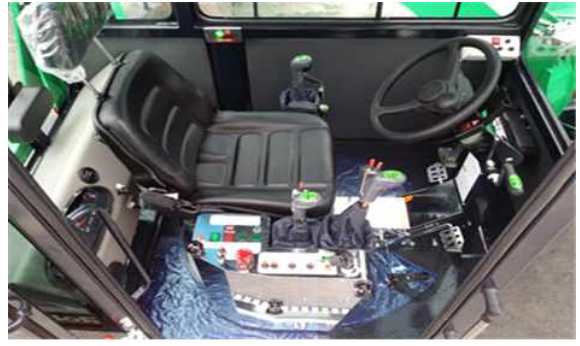
[운전석 회전시스템 후방 135°(좌), 후방 180°(우)]
