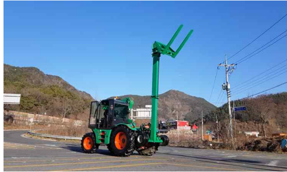
[텔레스코픽 암을 이용한 운반, 이동 테스트]
