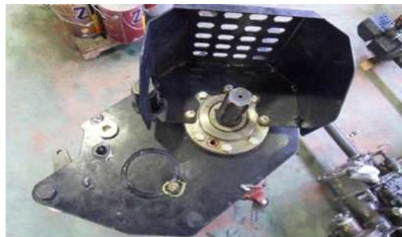
[PTO(좌) 및 PTO 하우징 제작]
