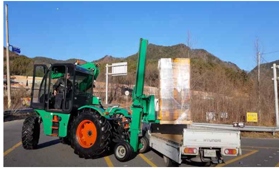
[텔레스코픽 암을 이용한 상·하차 테스트]
