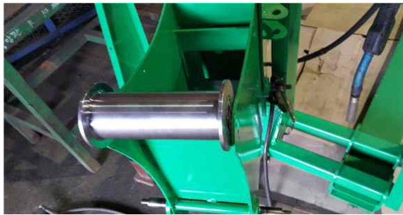
[ 슬라이딩 구조(좌), 슬라이딩 및 틸팅부 시제품(우) ]
