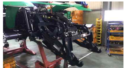
[작업기 부착 시스템 조립]
