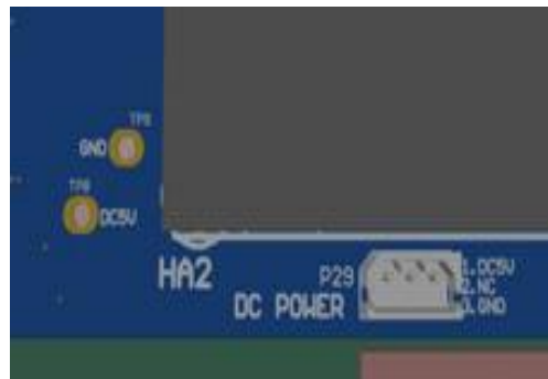
[Power 콘덴서 추가 및 DE10 전원 콘넥터 신설]
