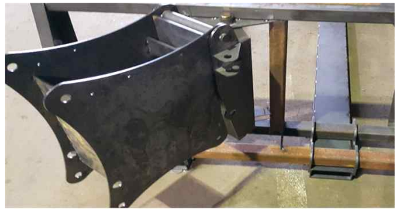
[ 슬라이딩 구조(좌), 슬라이딩 및 틸팅부 시제품(우) ]
