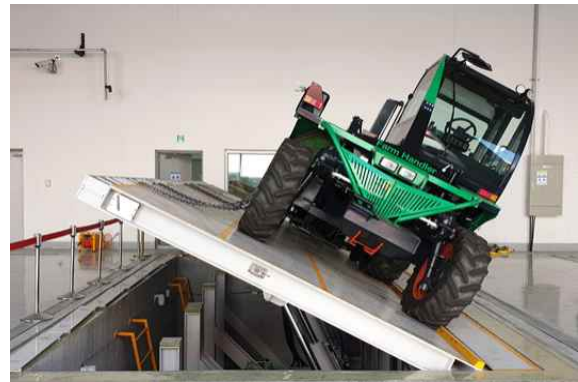
[2차년 공인검정기관(FACT) 무게중심 측정장치(좌)와 전도 측정장치(우)]
