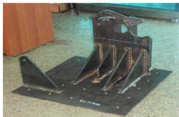
[기어 케이스 및 기어케이스 지그 제작]
