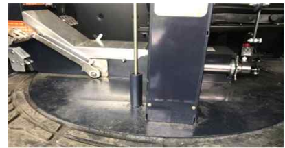
[쿠션 조절 및 경고음 조절 레벨(좌), 운전석 완충 쿠션장치(중), 운전석 회전판(우)]
