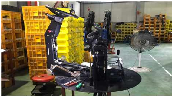
[운전석 회전시스템 시제품 제작(조작패널 조립)]
