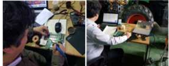
[유압제어 콘트롤 유닛 제작(좌), 유압 제어시스템 개발(우)]
