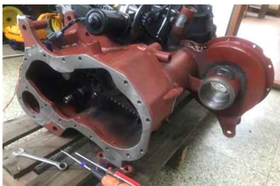
[기어 케이스 및 기어케이스 지그 제작]
