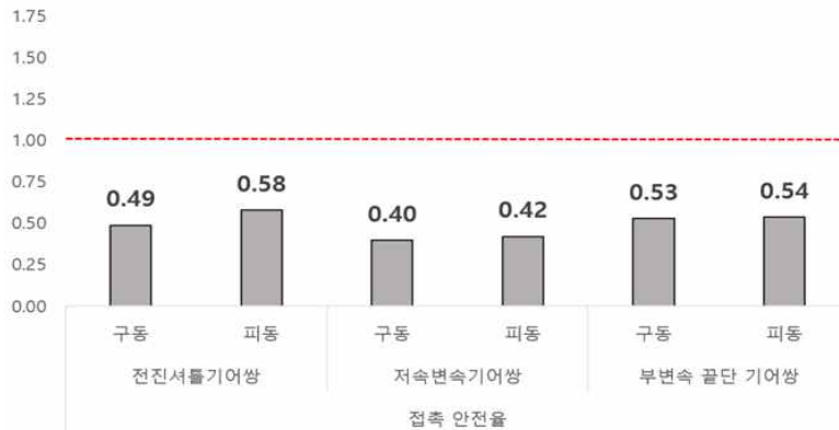
[텔레스코픽 동력 본체 엔진 정격부하에 대한 전·후진 및 부변속부 기어쌍 접촉 안전율]
