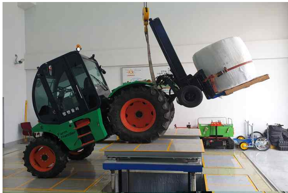
[2차년 공인검정기관(FACT) 무게중심 측정장치(좌)와 전도 측정장치(우)]
