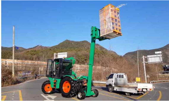
[텔레스코픽 암을 이용한 운반, 이동 테스트]
