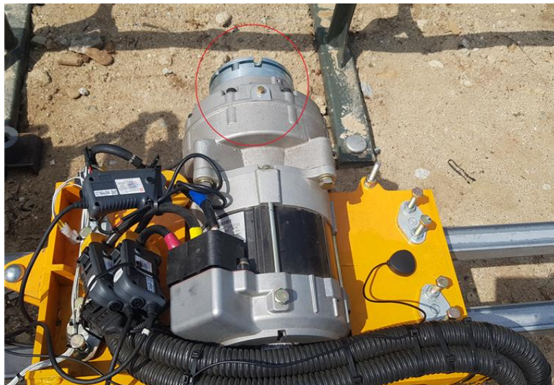
[그림] AC 모터에 취부된 EM Break 및 유압 Disk Break
