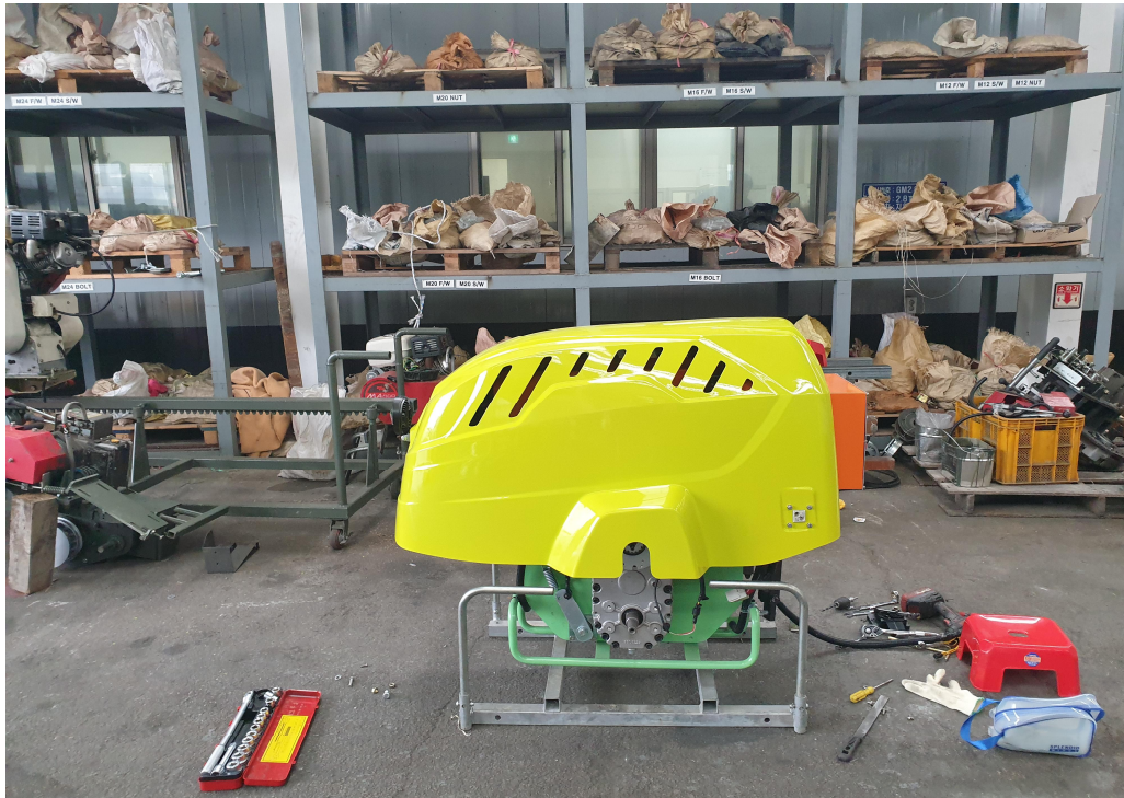
[그림] 구동부 실제 제작 및 장착 사진
