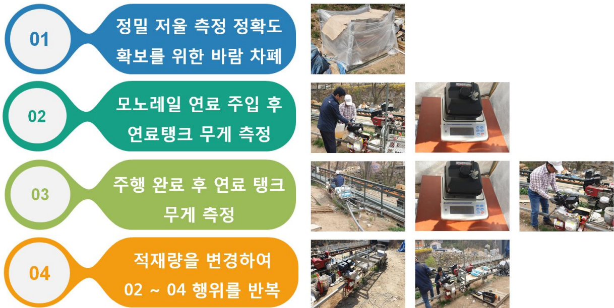
[그림] 연료 소모량 평가 시험 절차_*Ref)KSME-DC19-P054
