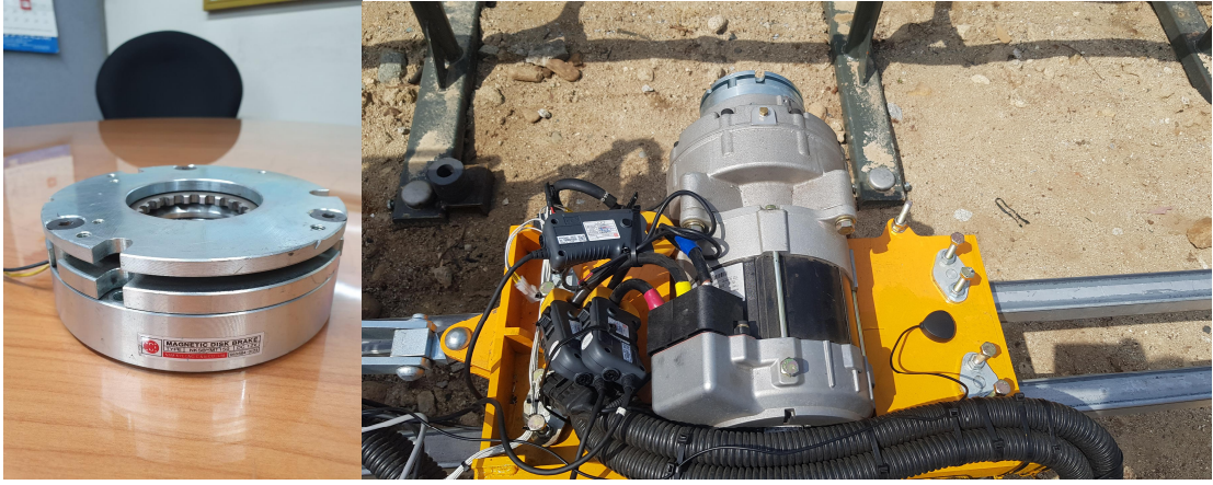
[전자식 브레이크와 장착 사진]
