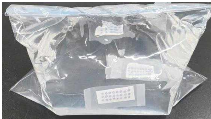
그림 66. 500g 물주머니와 부착된 멤브레인 센서
