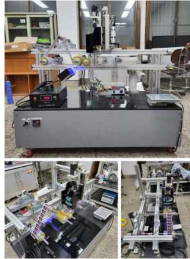
그림 7. 온도 감응형 지시계 연속생산 장치
