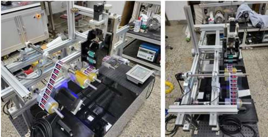
그림 95. 제작을 완료한 롤투를 연속생산장치.
