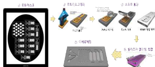
그림 2. 미세유체칩 제조 공정
