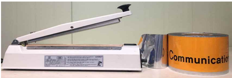
그림 10. 시제품 포장필름 및 가열접착식 sealer.
