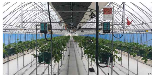
그림 52. 딸기 병해 확산 방지를 위한 레일 병해 방제 시스템
