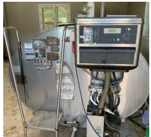
2열 6두의 헤링본 착유시설. 한 번에 12마리의 소를 착유할 수 있어 작업시간이 크게 줄었다. 젖소 착유시설에서 짠 원유가 자동으로 모이는 원유 냉각시설.
