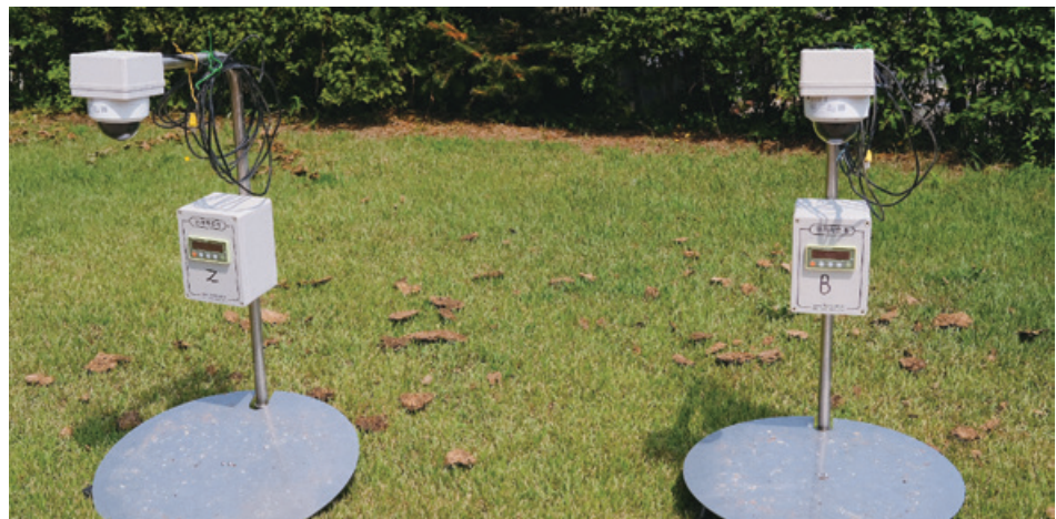
경기도농업기술원과 연천군농업기술센터가 추진한 시범사업을 통해 임씨가 농장에 마련한 '육계중량 자동측정 모니터링 시스템'의 설비 일부
