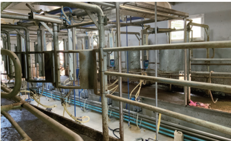
2열 6두의 헤링본 착유시설. 한 번에 12마리의 소를 착유할 수 있어 작업시간이 크게 줄었다. 젖소 착유시설에서 짠 원유가 자동으로 모이는 원유 냉각시설.
