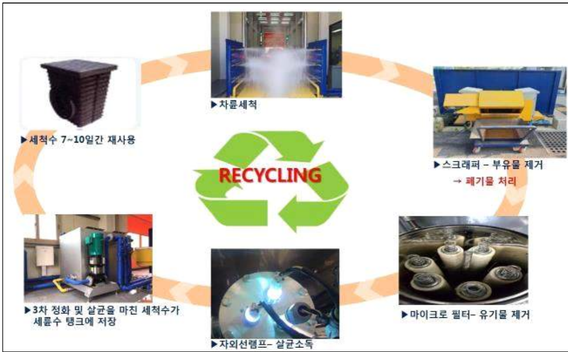
그림 17. 세차수의 친환경 Recycling System의 모식도
