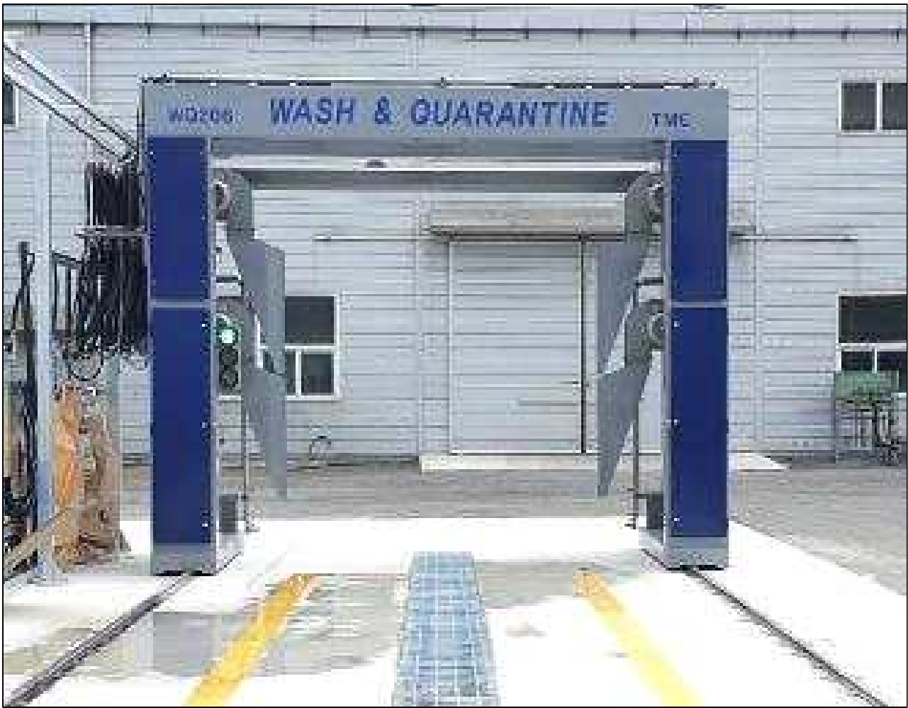
그림 25. 자동 세척 & 소독장치의 설치 사진
