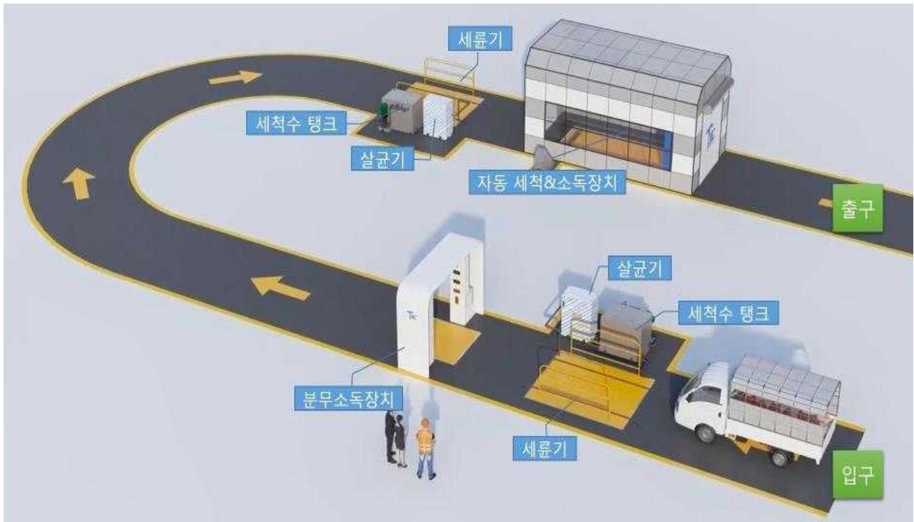
그림 14. 친환경 축산차량의 세척/소독 일괄 시스템의 모식도
