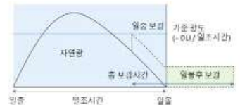
〈그림 3.15〉 일출 이후에 보광을 실시하는 경우 온실 내 일조 광도의 변화 양상
