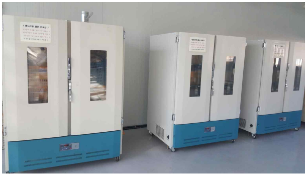
드라이오븐(건물중 측정, 한백과학)
