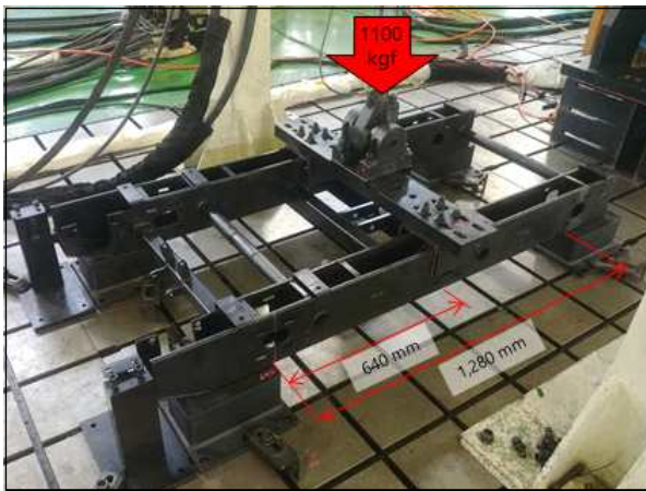
그림. 셋업 사진(모멘트 길이 1,280mm)
