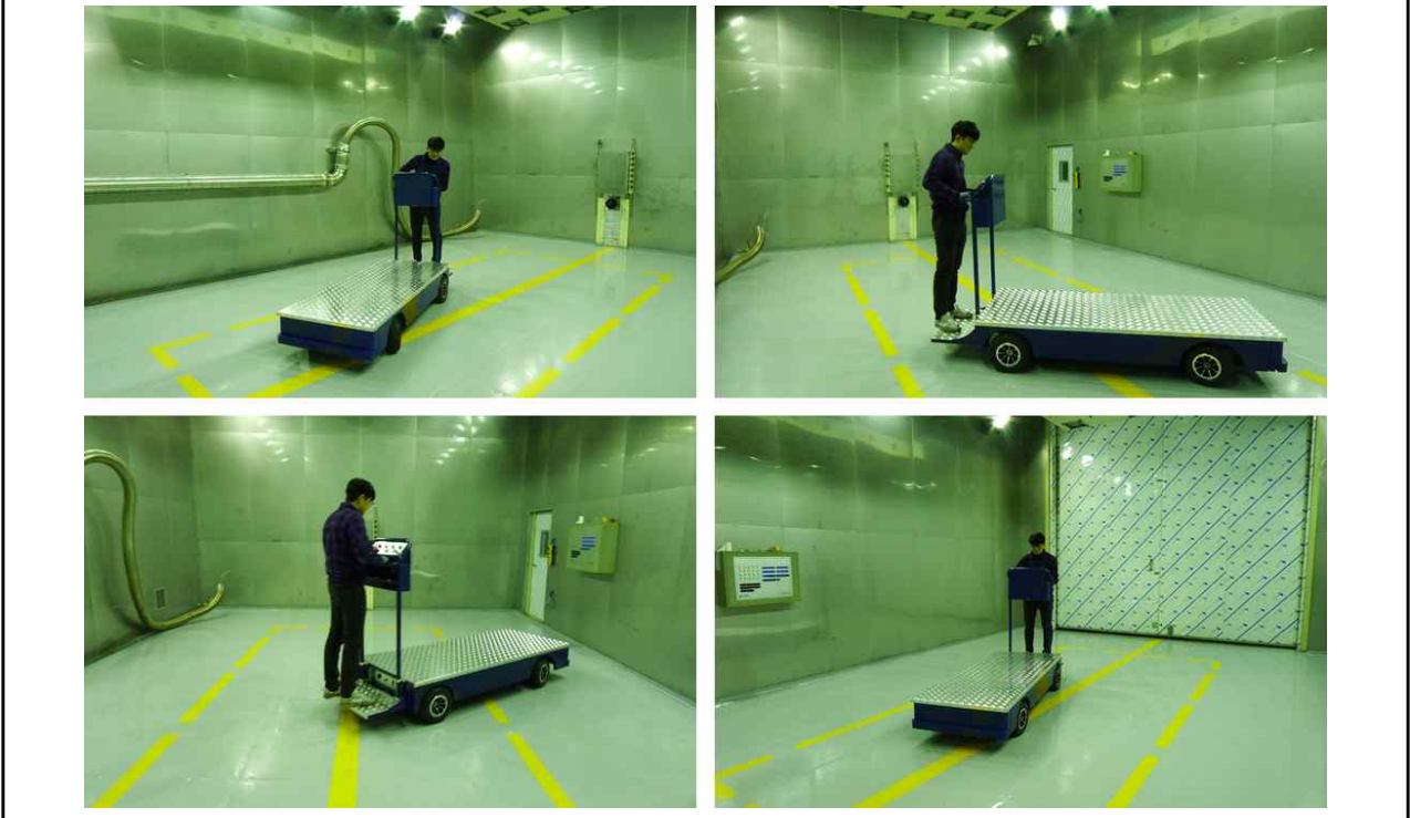
[그림 44] 내열성 시험 완료 후 무인전기작업차 작동 모습
