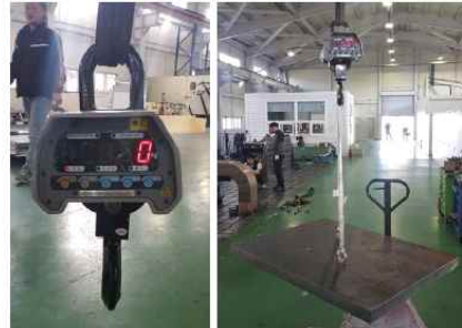
[저울 0점 세팅 및 농자재 수송차량에 적재할 중량물(507kg)]
