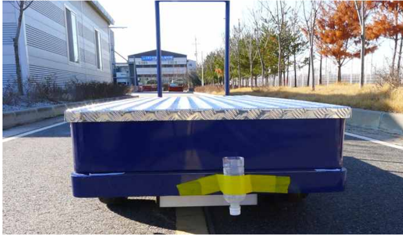
[그림 33] 잉크 궤적 기반 자율 주행 측정 방법
