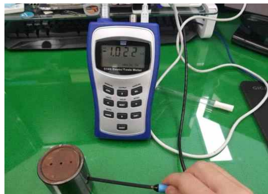
1kG 표준 자석을 이용한 자계 세기 측정
