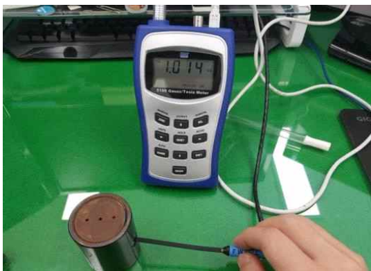
1kG 표준 자석을 이용한 자계 세기 측정
