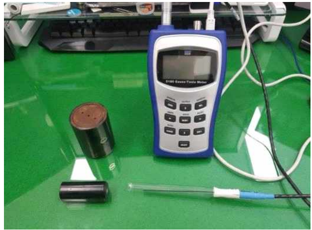
[그림 11] 자계 측정 실험 환경 구성
