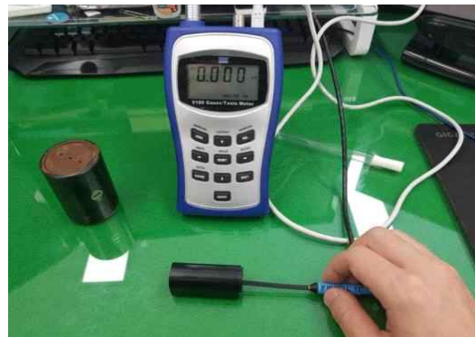
[그림 12] 제로 플럭스 챔버를 이용하여 실험장비의 영점 설정
