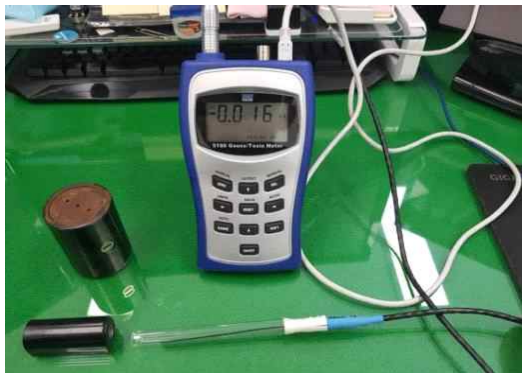
[그림 12] 제로 플럭스 챔버를 이용하여 실험장비의 영점 설정
