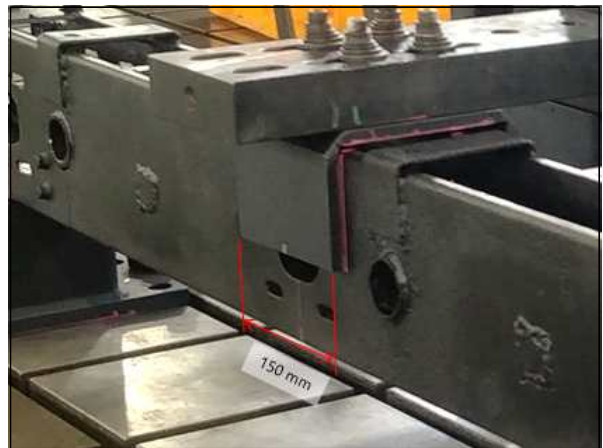
그림. Center 가진부 사진(놀림 길이 150mm)
