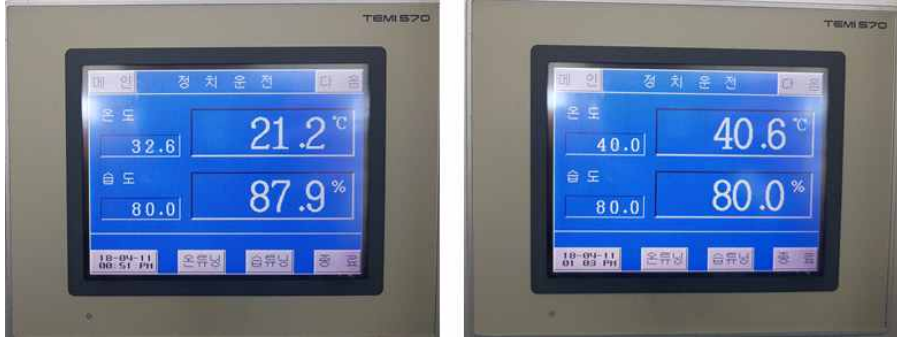
환경챔버_항온항습 실험_ 영상 40도, 습도 80%, 1시간 유지
