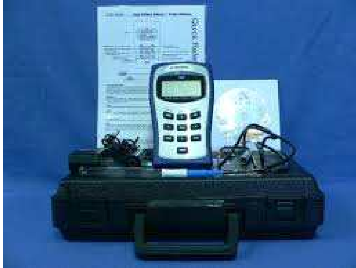
[그림 9] 휴대용 자계 측정기 (FW BELL 5180 Gauss/Telsa Meter)
