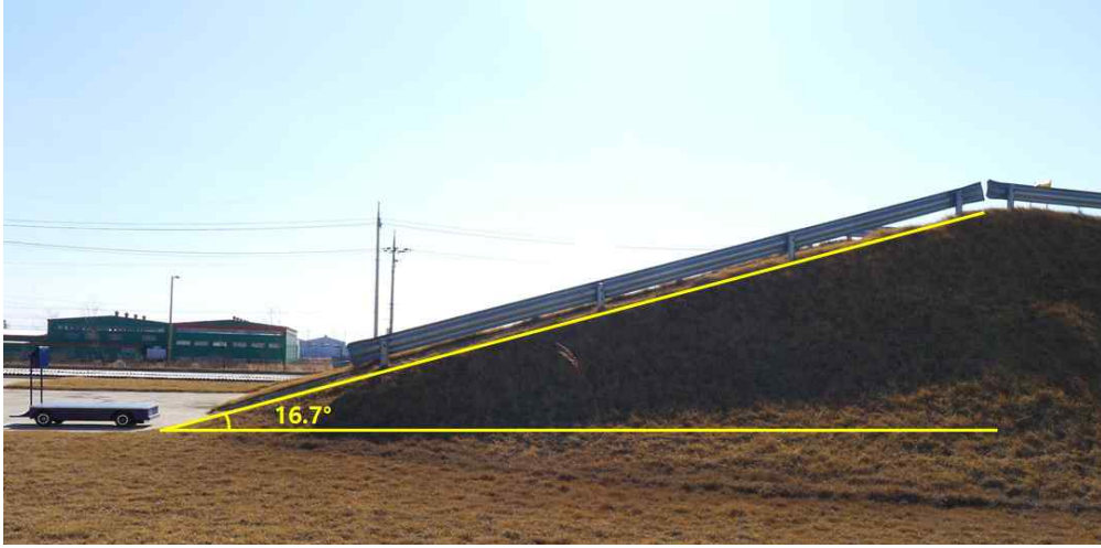
[그림 36] 등판 능력 시험 경사로
