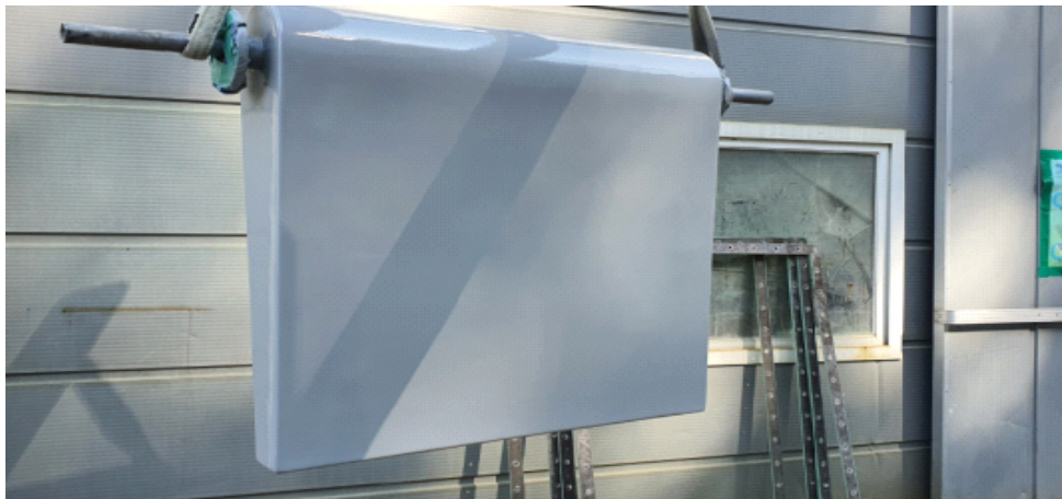
<그림 4-31> 수문 게이트 GFRP 가공
