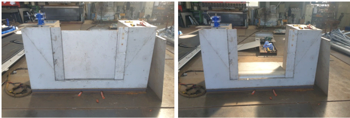
<그림 4-30> 프로토타입 제작 완료(기립, 도복 형상)
