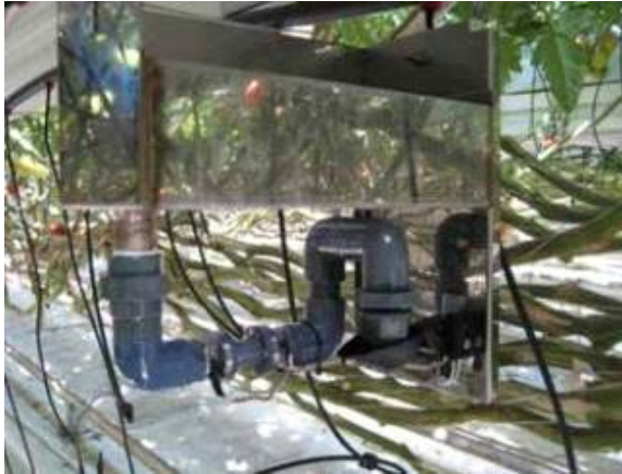
<Priva Drain Sensor(배액 정보 측정)>
