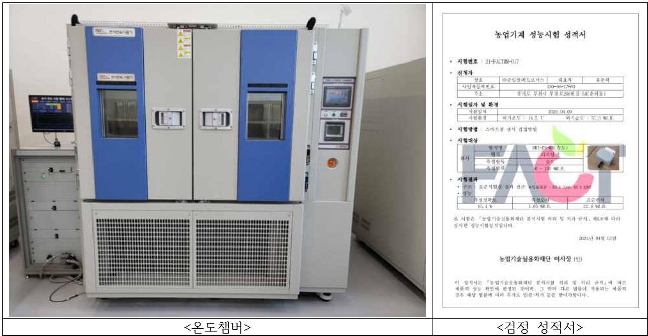
그림 19. 스마트 온실 센서 검정용 챔버 및 성적서
