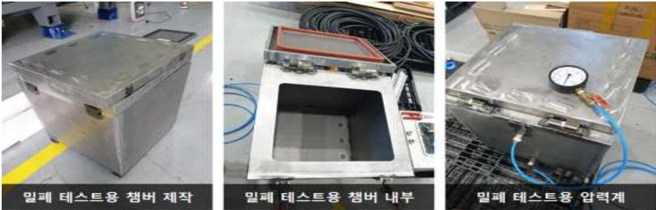
그림 103) 소형 챔버 밀폐 테스트
