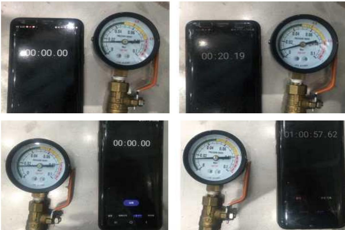
그림 104) 고무패킹 밀폐테스트(상), O-ring 밀폐 테스트(하)
