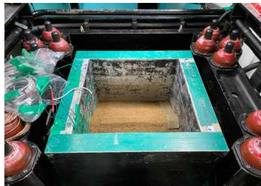
h. 원심모형진동박스에 설치
