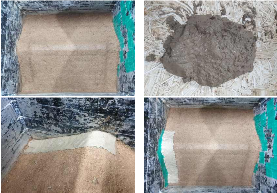
[그림 3.23] 월류 유도수로 모형 형성(Case 1, Case 2)
