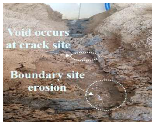
[그림 4.23] 복통균열부와 점토층 경계부에서 내부침식 (case 2)
