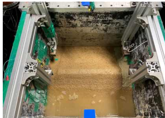
j. LVDT 및 고속카메라 설치
