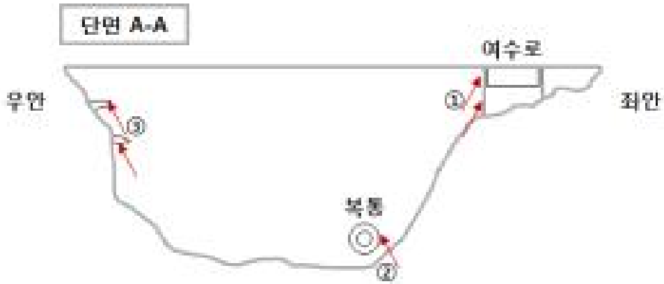
[그림 1.30] 필댐의 내부침식(파이핑) 취약부(A-A단면도)
