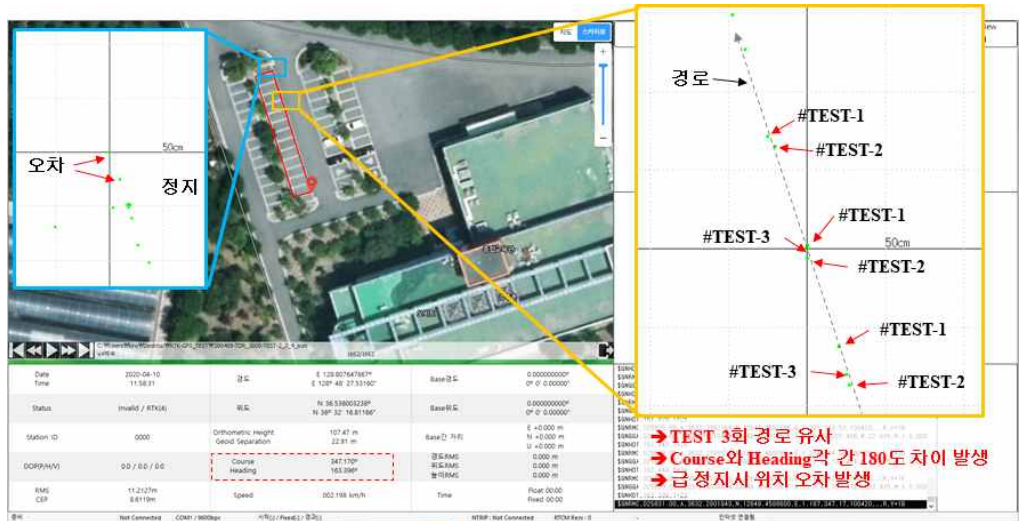
<고가의 GPS 보정신호 수신기 성능 확인 결과(위치 및 heading 각 오차)>
