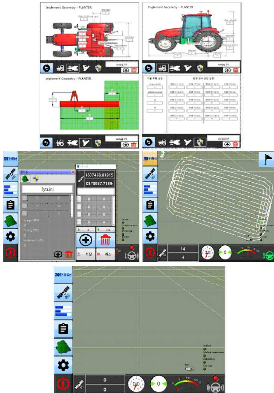
그림 15 그림자울주행 경로 생성 및 추종 제어기 GU
