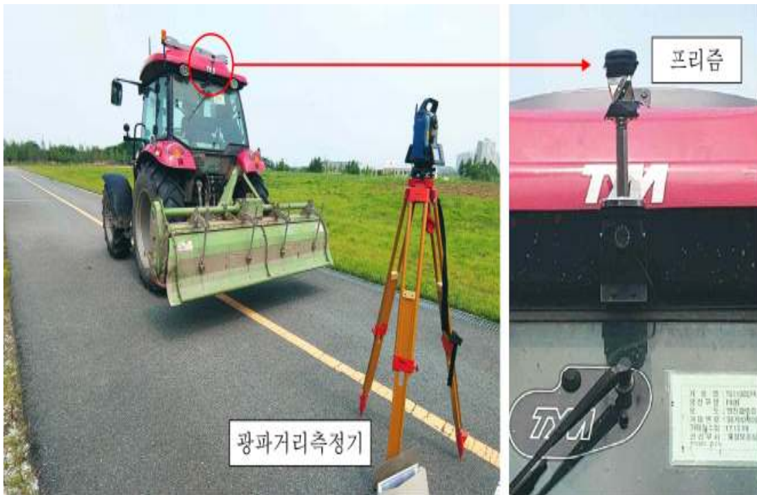
그림 20 자율주행트랙터 경로오차 시험 장비 구성
