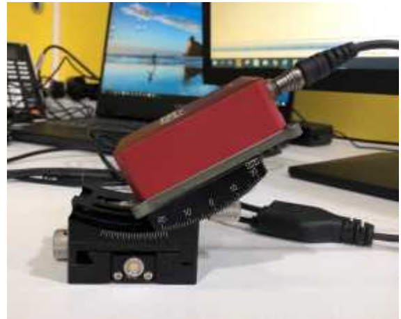
IMU가 설치된 각도조절 지그
