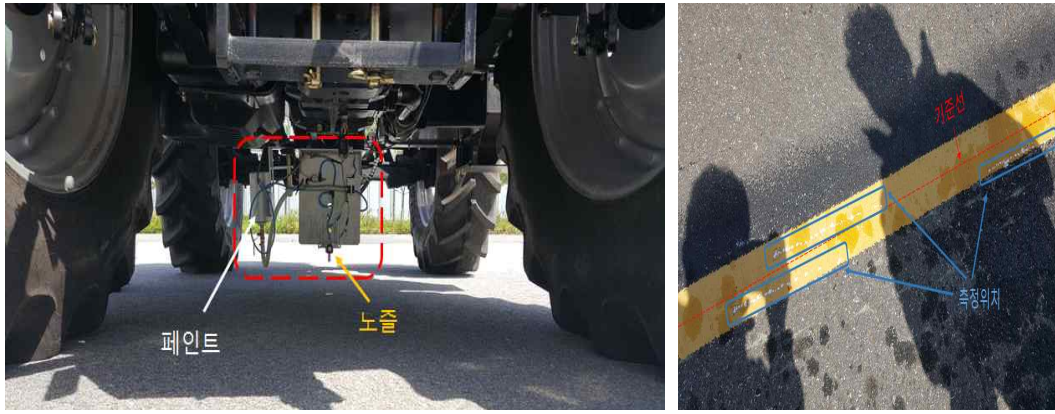
<페인트 Dropper 설치 모습 및 주행 궤적 표시>
