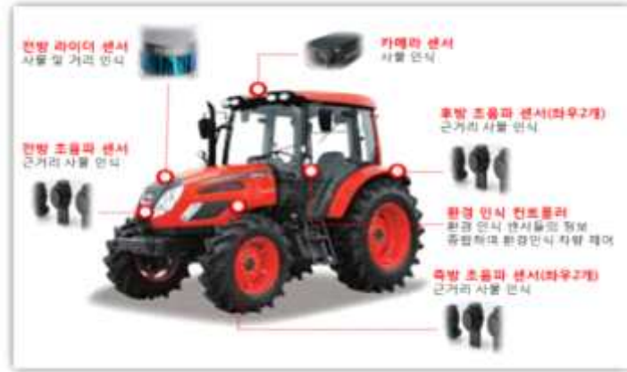
<자율주행 트랙터 시스템 센서 구성>
