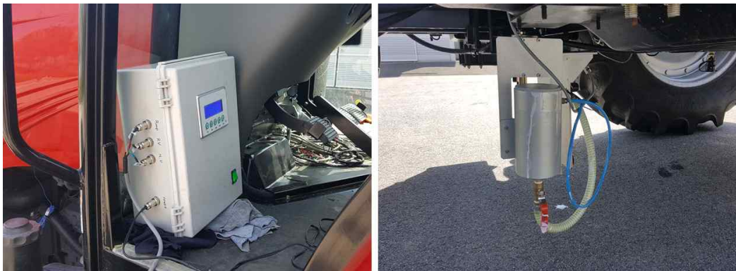
<페인트 Dropper (좌 : 컨트롤러, 우 : Dropper 노즐)>
