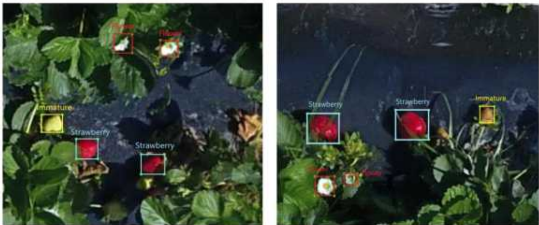
그림 681 환경인식 시스템 영상인식 및 대상 판단에 대한 결과
