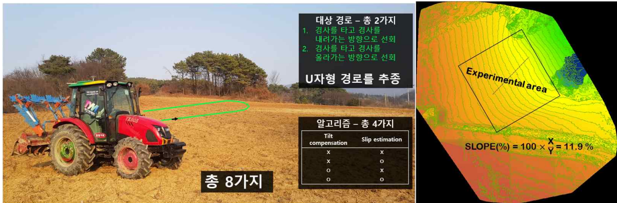
< 현장 요인실험 환경 현장사진 (좌)과 경사도 측정 결과 (우) >
