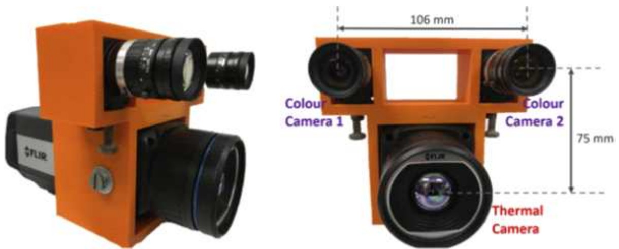
< 이미지 registration을 위한 2 개의 컬러 카메라와 열 화상 카메라 >
