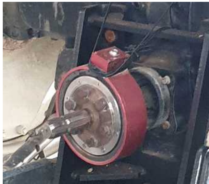
< 부하 계측 트랙터에 설치된 PTO 토크미터 >
