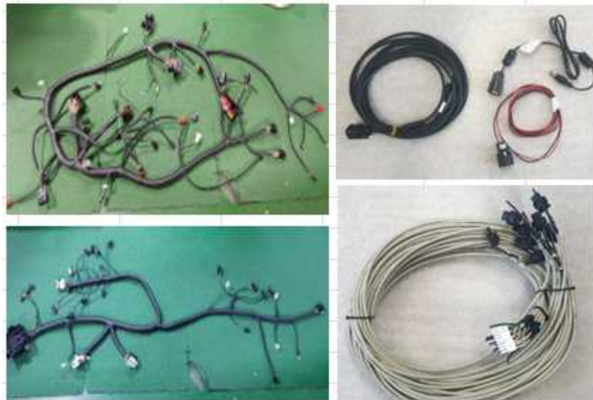
< 전장 시스템 와이어 하네스 시제품 개발 >
