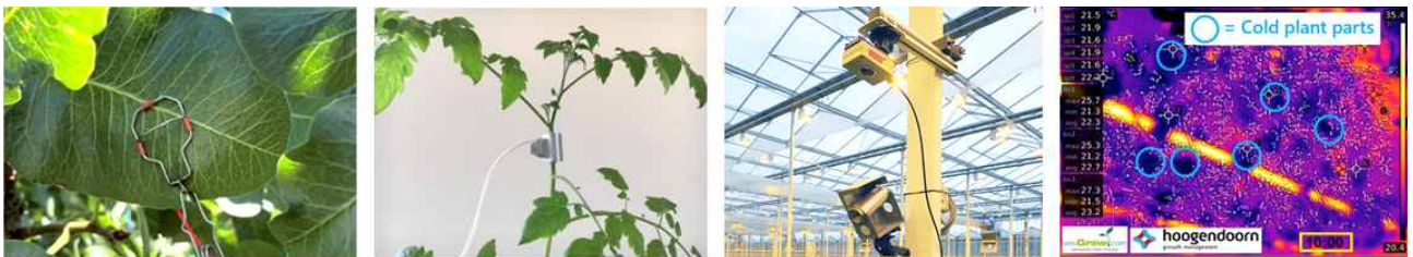
[그림 6-10] 엽온센서, sap flow 센서, 균락온도센서(자료출처 엽온센서 및 sap flow 센서, implexx; 균락온도센서 hoogendoorn, Sensor BV, LetsGrow.com)
