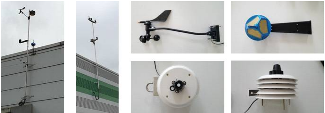
[그림 6-9] 외부 환경측정장치 및 기상대 부속 센서
